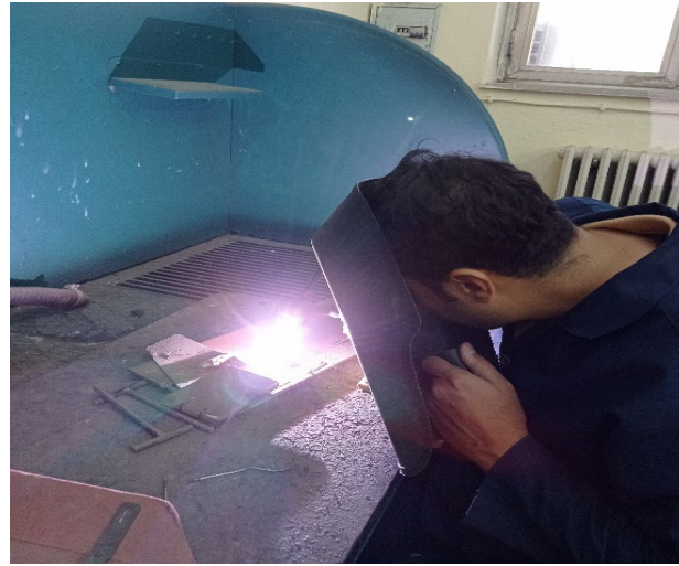
Şekil 4.13. GTA yöntemi kaplama işlemi
