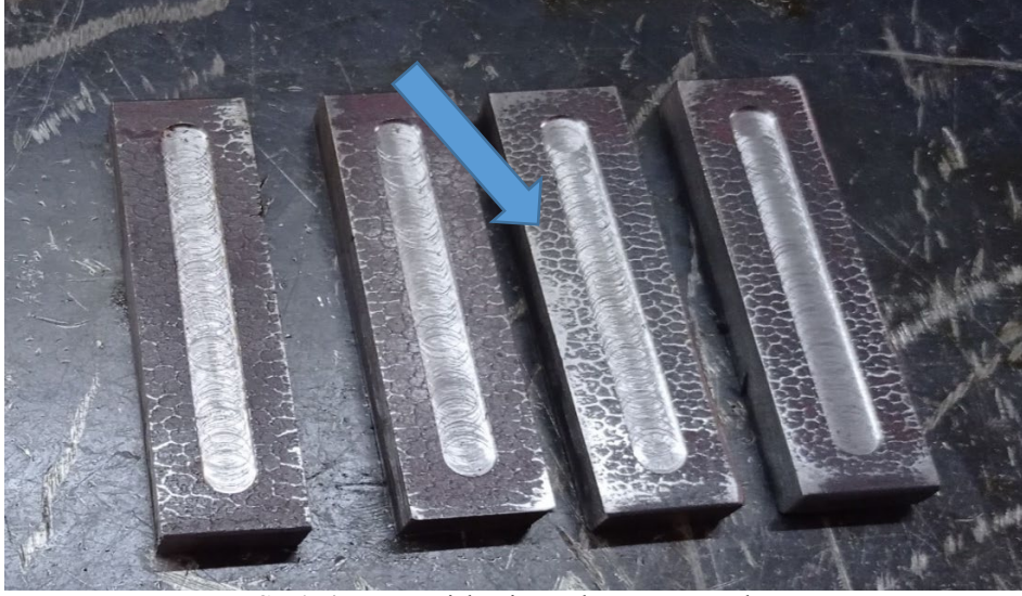
Şekil 4.5. Freze işlemi tamamlanan numuneler
