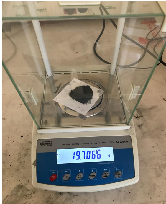
Şekil 4.8. Hassas terazide tozların ölçümü
