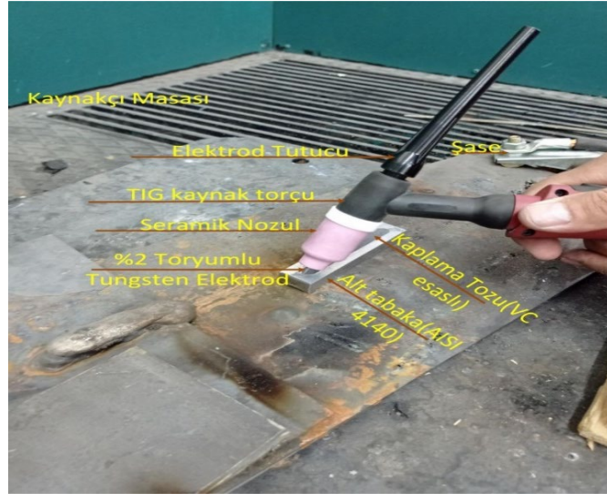
Şekil 4.12. Kaplama işlemine hazırlık aşaması
