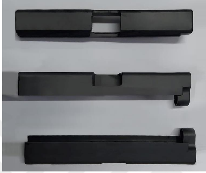
Şekil 16. İkinci kumlama ve ikinci oksidasyon işlemleri sonrası kapak numuneleri
