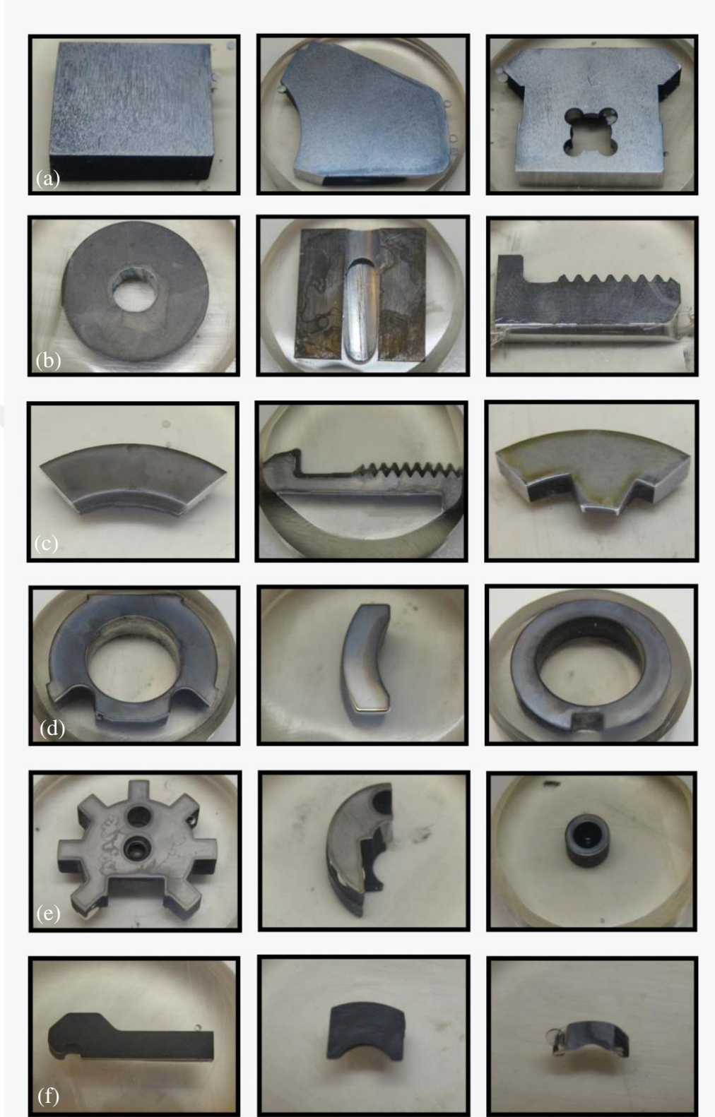
Şekil 5. Hafif ateşli AR-15 tipi tüfek parçalarından alınan dağlanmış örnek numuneler [45]: (a) Gövde, (b) Namlu, (c) Namlu hamili, (d) Mekanizma, (e) Döner başlık ve (f) Tırnak parçaları
