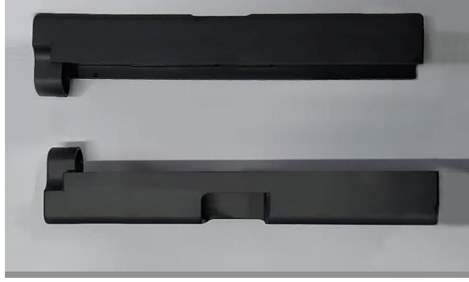
Şekil 17. Koruyucu yağ banyosu daldırılmış kapak numuneleri
