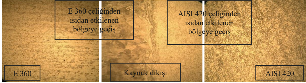
Şekil 6.3. D-2 numaralı deneye ait mikroyapı görüntüleri.
