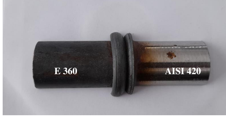
Şekil 5.2. D-1 parametre grubu sürtünme kaynağı numunesi.
