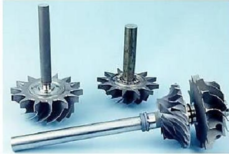
Şekil 3.21. Sürtünme kaynağı ile üretilmiş uçak parçası.
