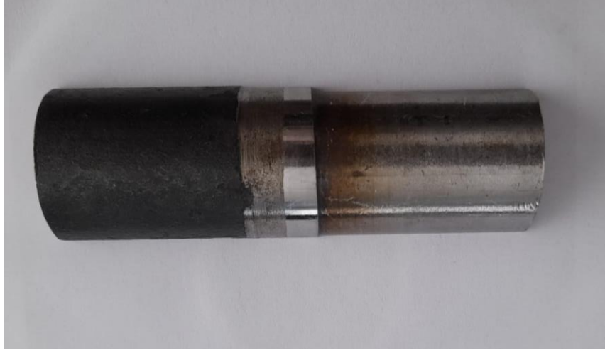
Şekil 5.4. Çapağı temizlenen numune.
