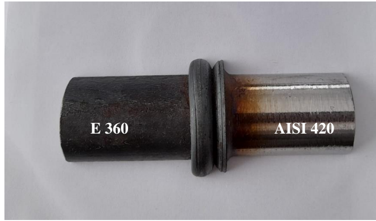
Şekil 5.3. D-2 parametre grubu sürtünme kaynağı numunesi.
