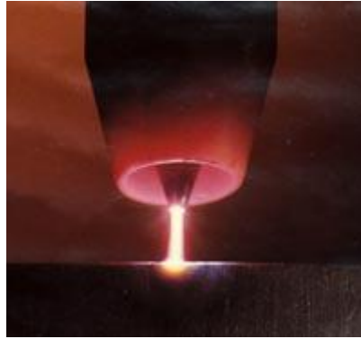
Şekil 2.21. Plazma ark kaynak nozulu (URL-7, www.pro-fusiononline.com , 2009).
