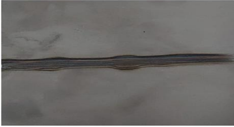
Resim 8. 3. Mikro plazma ünitesi ile aln alına birleştirilmiş deney parçası
