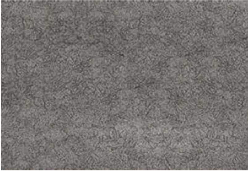
Şekil 2.7. Martenzitik paslanmaz çelik mikro yapısı
