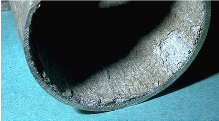
Resim 2. 5. Taneler arası korozyon örneđi
