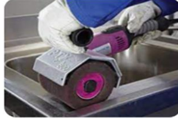
Resim 8. 8. Manuel parlatma makinesi ve teknik verileri
