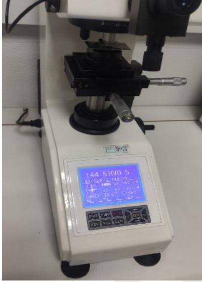
Resim 9. 3. Lazer kaynak dikişi sertliğinin ölçülmesi
