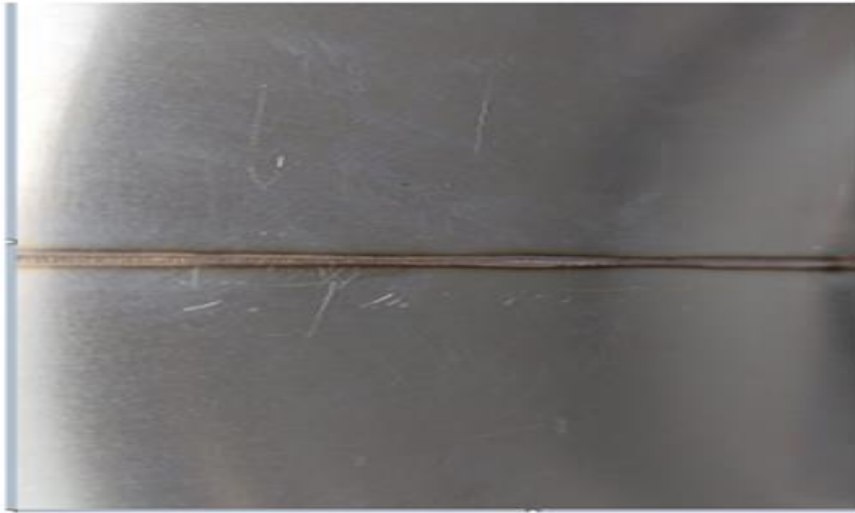
Resim 8. 7. Lazer kaynak ile alın alına birleştirilmiş deney parçası
