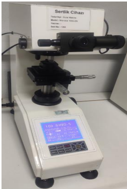
Resim 9. 5. Plazma kaynak dikişı sertliğinin ölçülmesi
