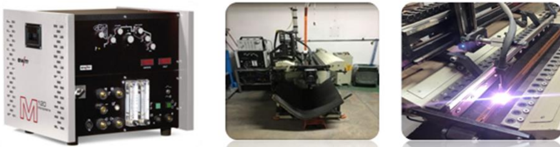
Resim 8. 2. Mikro plazma ünitesi ve kontrol mekanizması
