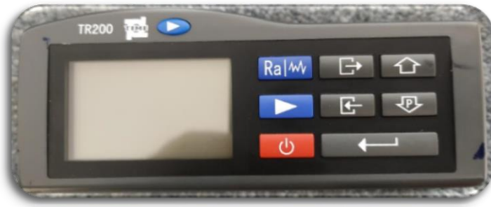
Resim 8. 14. Yüzey pürüzlülük ölçüm cihazı TR-200 (3200)
