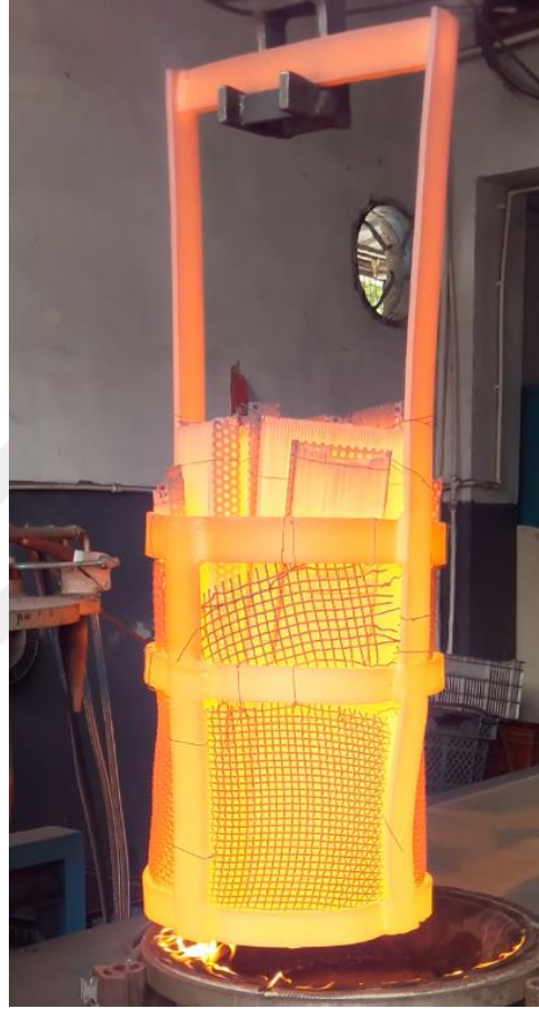
Şekil 1.20 Martenzitik paslanmaz çeliğin ısıtılması
