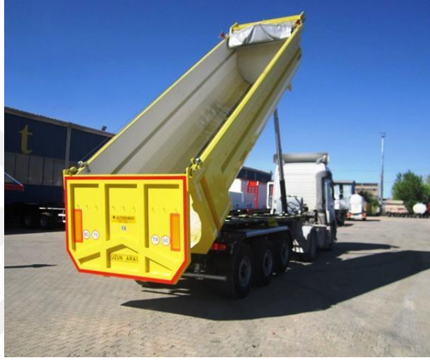
Şekil 1.26 HARDOX çeliğinden yapılmış bir kamyon kasası [34]
