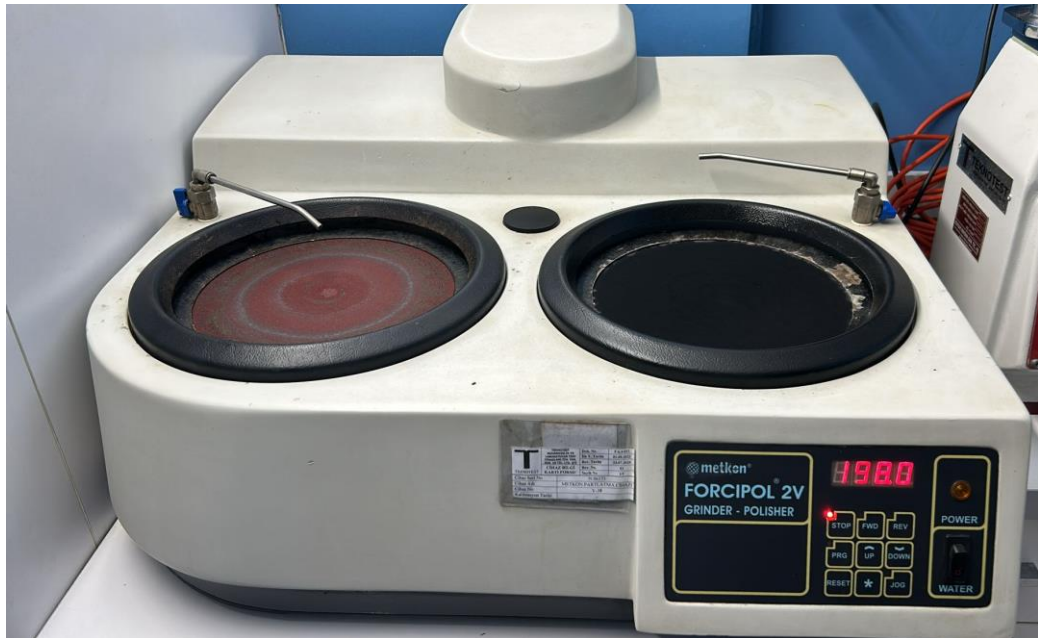
Şekil 3.14. Numune hazırlamada kullanılan zımparalama ve parlatma cihazı
