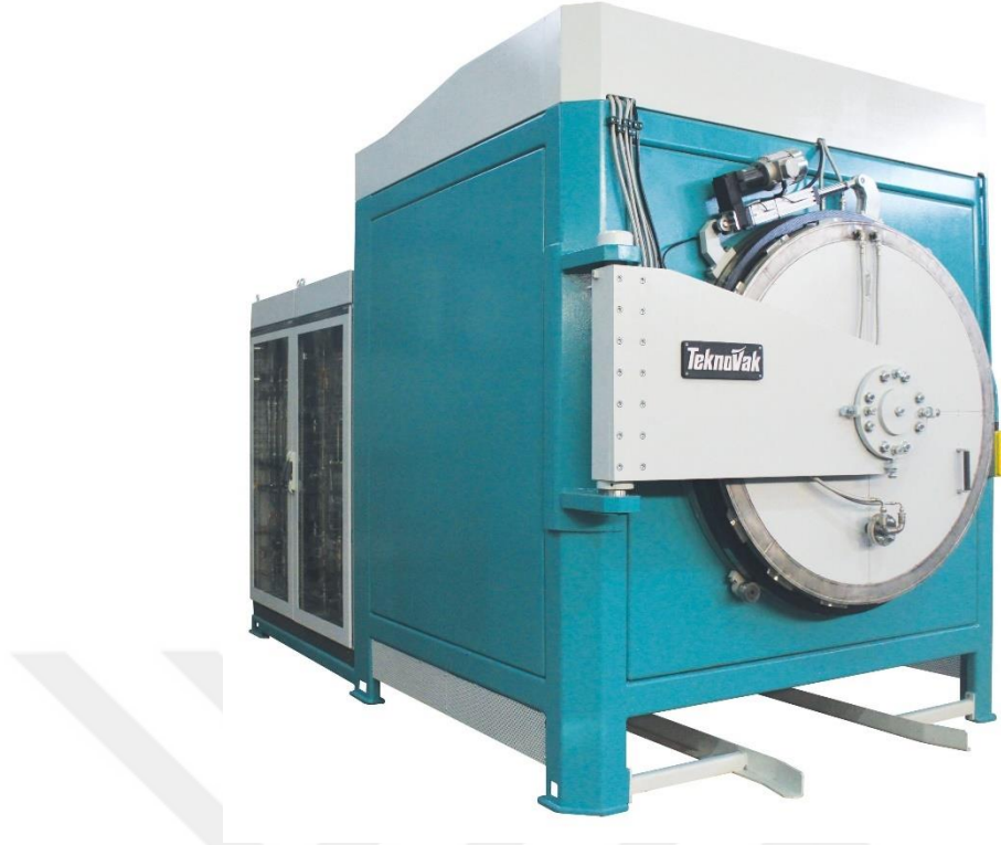
Şekil 3.11. Nitrasyon işleminin gerçekleştiği fırın
