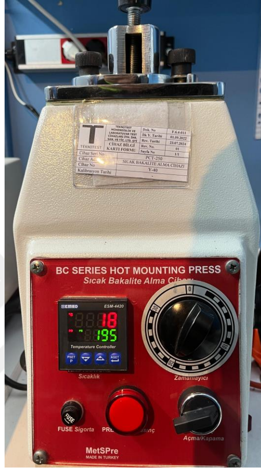
Şekil 3.15. Numune hazırlamada kullanılan bakalitleme cihazı
