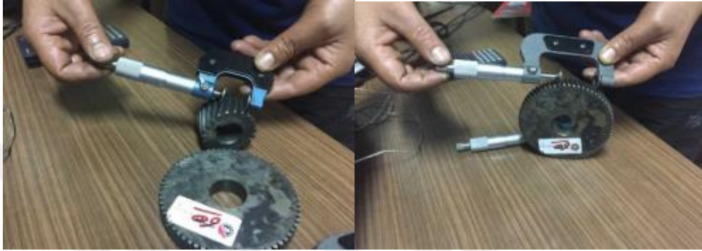
Şekil 2.15. AISI 5115 (solda) ve AISI 8620 (sağda) malzemeden imal edilmiş dişli çarkların yüzey sertleştirme işlemleri sonrası boyut ölçümü Gençoğlu (2019)
