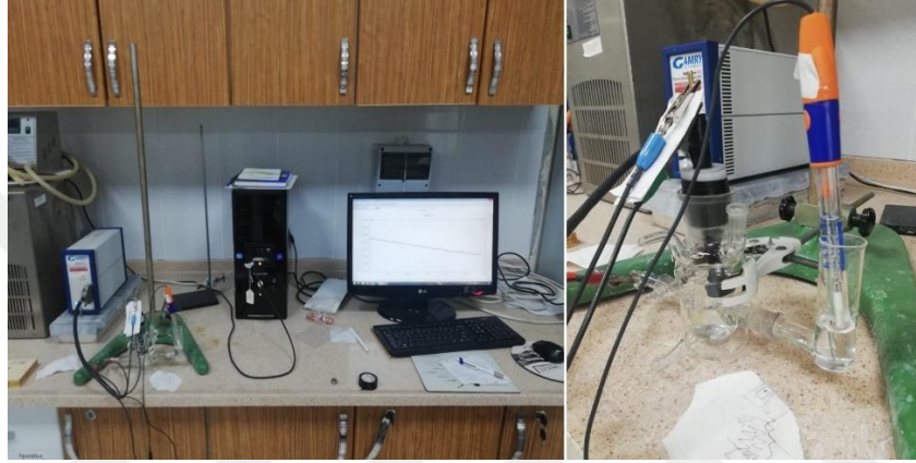
Resim 3.9. Korozyon deneyinde kullanılan cihazlar ve deney düzeneği fotoğrafı.
