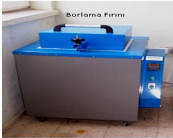
Resim 3.4. Borlama işleminde kullanılan kuyu fırının fotoğrafı.
