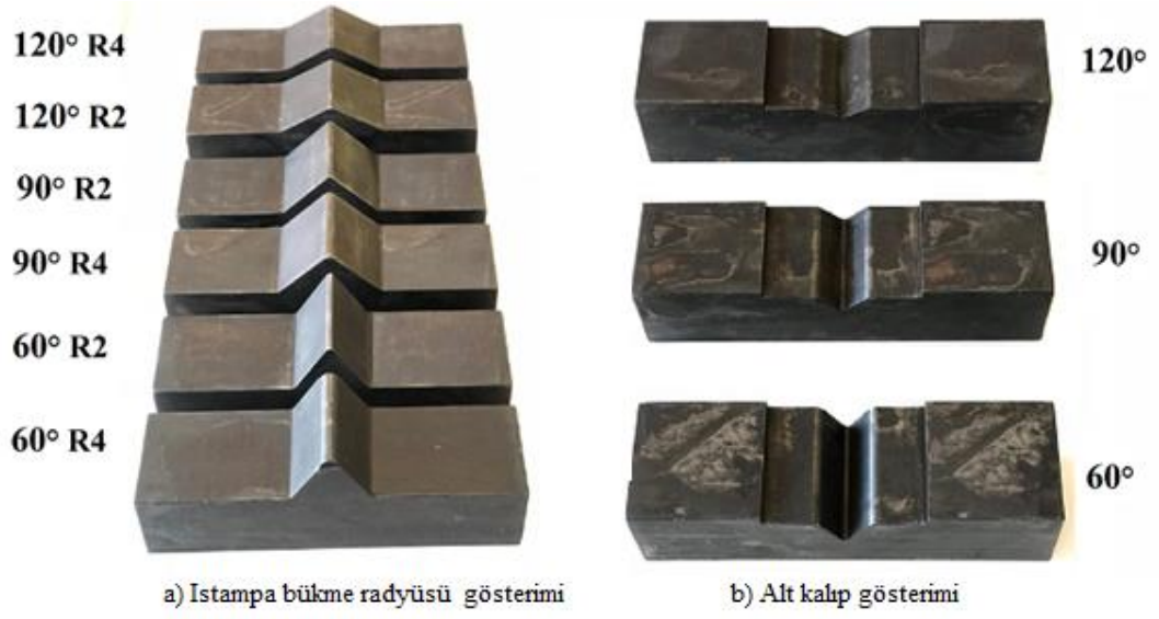
Şekil 3.3. Kalıp açısına göre büküm radyüsleri ve alt kalıp örnekleri
