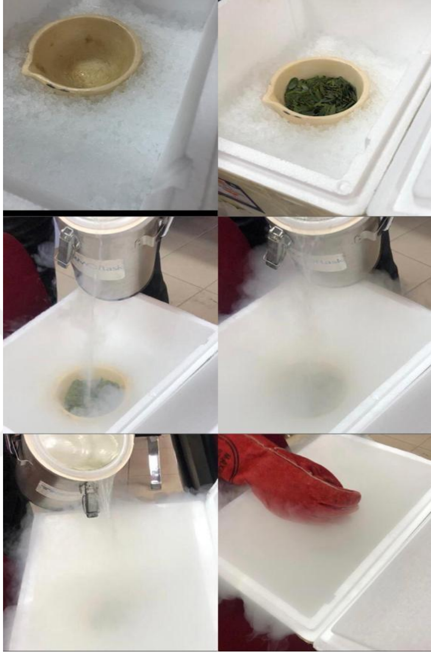
Şekil 3.2. Sıvı azot kullanarak Akçakesme ( Phillyrea latifolia ) bitkisinin yapraklarının parçalanması işlemi
