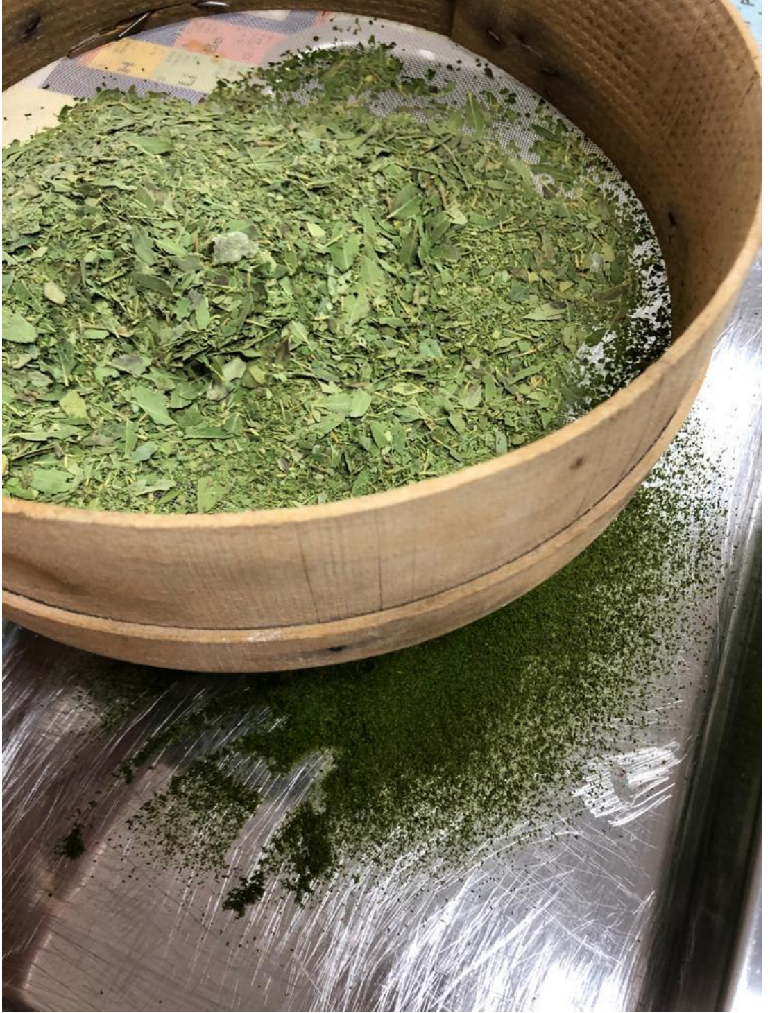
Şekil 3.5. Sıvı azot yöntemiyle parçalanmış ve öğütülmüş numunenin elekten geçirilmesi
