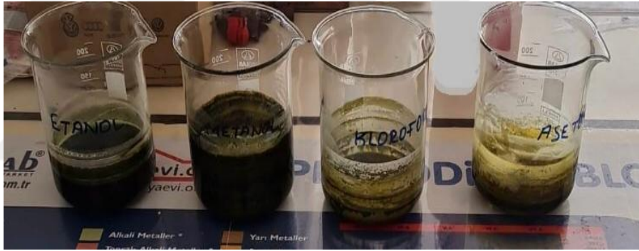
Şekil 3.13. Solventler uçana kadar ekstraktların bekletilmesi
