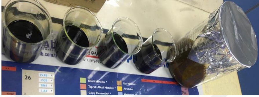
Şekil 3.12. Ekstraktların, solventler uçana kadar bekletilmesi
