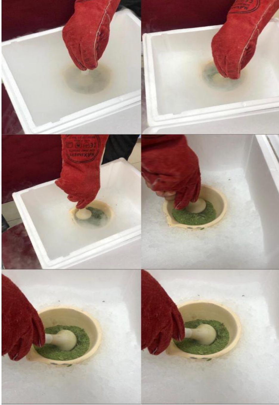
Şekil 3.3. Sıvı azot kullanarak Akçakesme ( Phillyrea latifolia ) bitkisinin yapraklarının parçalanıp porselen havanda öğütülmesi işlemi
