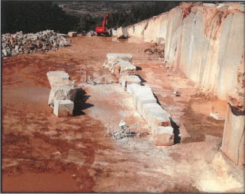
Şekil 3.9. Blok kesmeye yarayan büyük ve küçük motorlar
