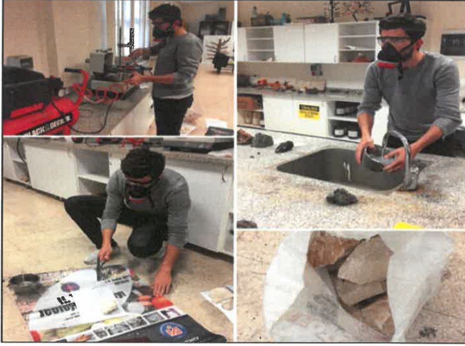
Şekil 3.14. Numunelerin analize hazırlanması kırma-öğütme işlemleri
