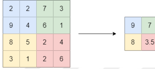
Şekil 3.27. Maksimum havuzlama tekniği
