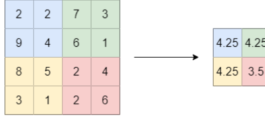
Şekil 3.26. Ortalama havuzlama tekniği
