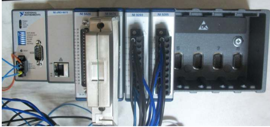
Şekil 5.3. c-RIO 9073 ve analog/dijital giriş/çıkış modülleri
