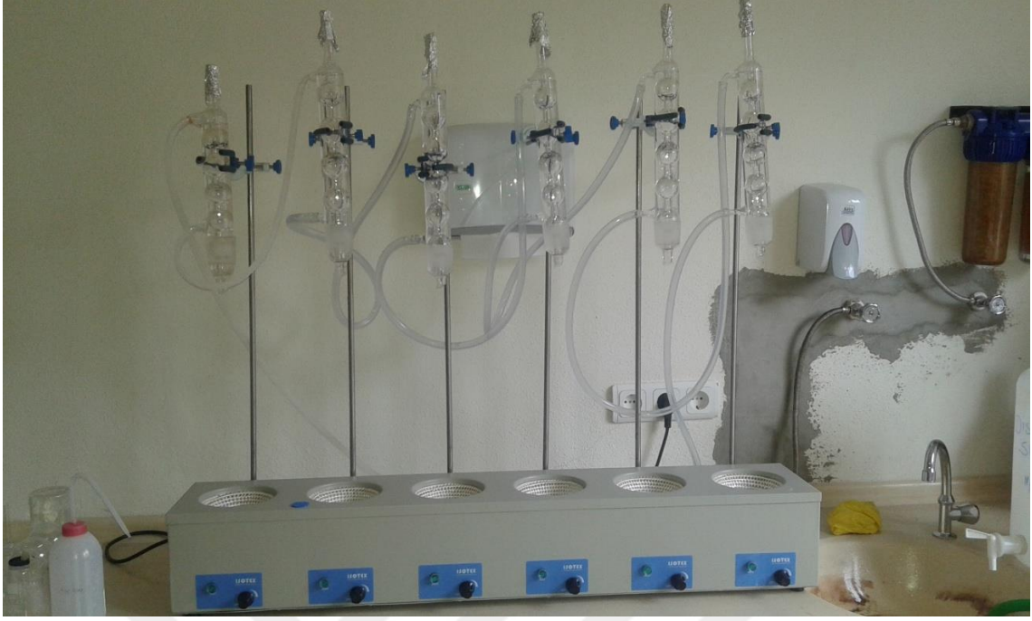
Şekil 15. Mantolu ısıtıcının hazırlanması
