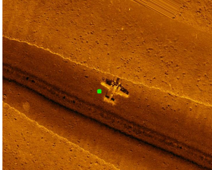
Figür 7: Sonar ile görüntülenmiş bir uçak batığı
