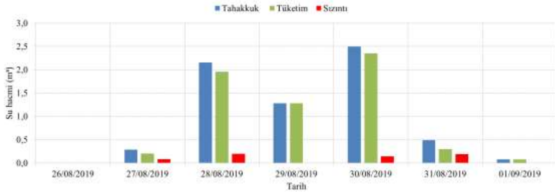
Şekil 4.28. Olbia bayan tuvaletinde 27.08.2019 (saat 09:00) – 01.09.2019 tarihleri arasındaki dönemde ölçülen toplam günlük tahakkuk su hacimleri, hesaplanan günlük sızıntı hacmi ve günlük tüketim su hacmi
