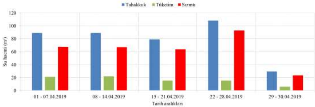
Şekil 4.145. Yakut Çarşısı tuvaletinde 2019 yılı Nisan ayında her analiz döneminde ölçülen toplam su tahakkuk hacimleri, hesaplanan toplam sızıntı ve tüketim hacimleri
