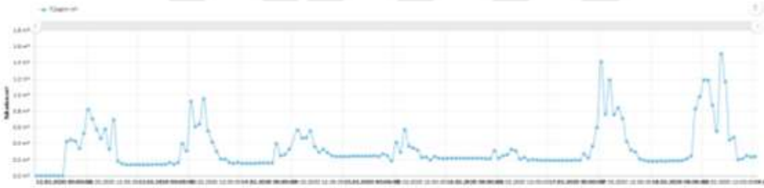
Şekil 4.214. Yakut Çarşısı tuvaletinde tuvalet arızası nedeniyle oluşan sızıntıları gösteren 12-19.02.2020 tarihlerine ait su tahakkuk verileri
