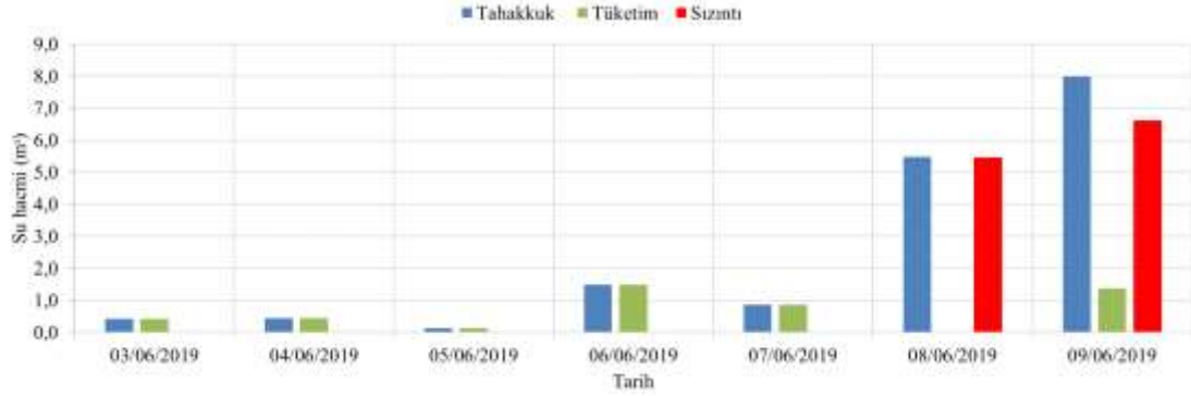
Şekil 4.19. Olbia bayan tuvaletinde 03.06.2019 – 09.06.2019 tarihleri arasındaki dönemde ölçülen toplam günlük tahakkuk su hacimleri, hesaplanan günlük sızıntı hacmi ve günlük tüketim su hacmi
