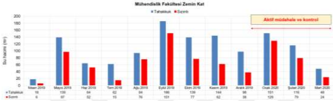
Şekil 4.194. Mühendislik Fakültesi zemin kat tuvaleti için su tahakkuk ve sızıntı hacimlerinin yıllık değişimi
