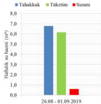
Şekil 4.29. Olbia bayan tuvaletinde 27.08.2019 (saat 09:00) – 01.09.2019 tarihleri arasındaki dönemde ölçülen toplam su tahakkuk hacmi, hesaplanan toplam sızıntı ve tüketim hacimleri
