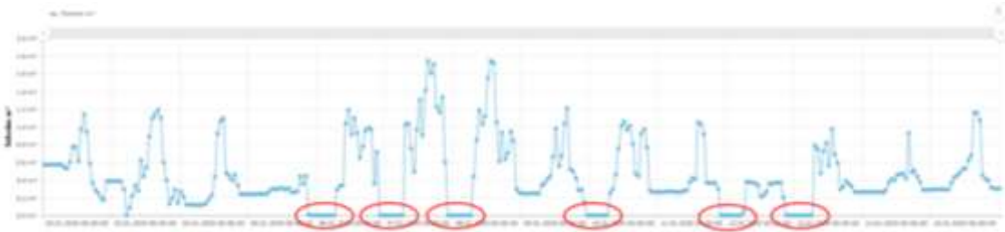
Şekil 4.211. Yakut Çarşısı tuvaletinde gece saatlerinde vana kapatılması ile su sızıntılarının azalması
