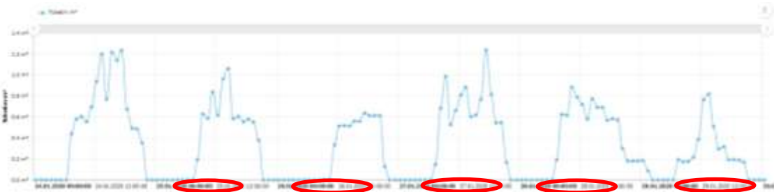
Şekil 4.212. Yakut Çarşısı tuvaletinde 24-30.01.2020 tarihleri arasında gece saatlerinde vana kapatılması ile su sızıntılarının azalması
