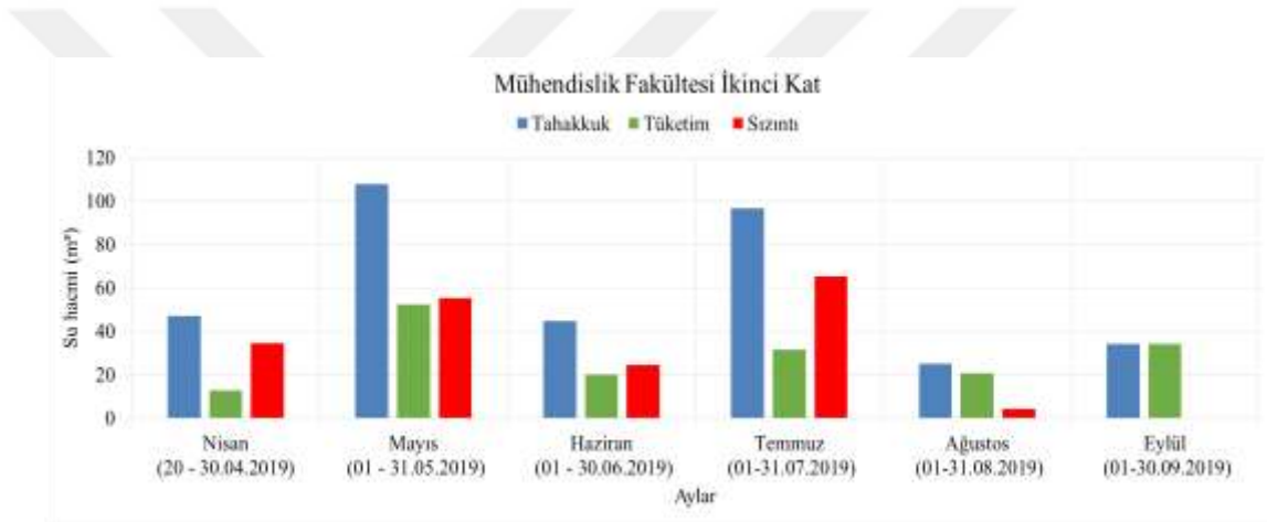
Şekil 4.121. Mühendislik Fakültesi ikinci kattaki tuvalet için Nisan-Eylül 2019 dönemine ait ilk altı aylık su tahakkuk analizi sonuçları
