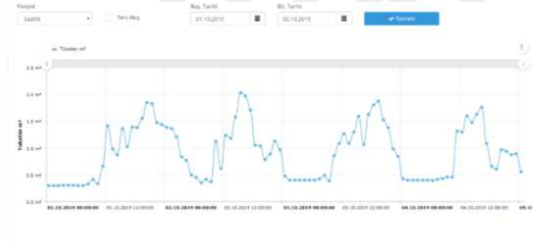
Şekil 4.2. Akdeniz Üniversitesi kampüsü içinde yer alan Yakut Çarşısı tuvaleti için kullanılan akıllı sayaçtan 01-05.10.2019 tarihleri için elde edilen su tüketimlerinin saatlik değişimlerini gösteren ekran görüntüsü
