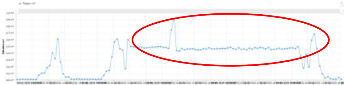
Şekil 4.187. Mühendislik Fakültesi 1. kat tuvaletinde 21-24.02.2020 tarihleri arasında tuvalet arızası nedeniyle oluşan sızıntılar
