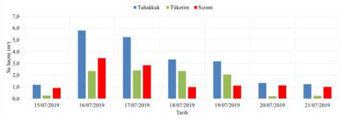
Şekil 3.18. Mühendislik Fakültesi zemin kat 15/07/2021-22/07/2021 tarihleri arasındaki haftalık tahakkuk-tüketim ve sızıntı değerleri
