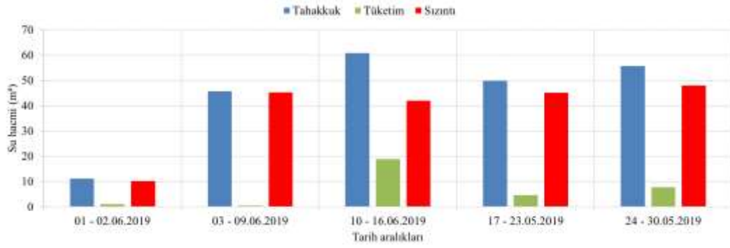
Şekil 4.151. Yakut Çarşısı tuvaletinde 2019 yılı Haziran ayında her analiz döneminde ölçülen toplam su tahakkuk hacimleri, hesaplanan toplam sızıntı ve tüketim hacimleri
