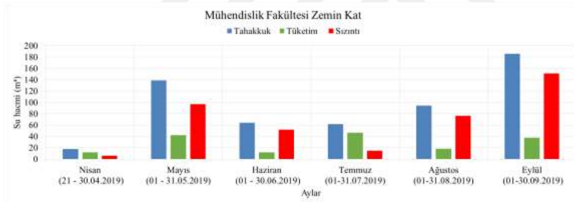
Şekil 4.77. Mühendislik Fakültesi zemin kat öğrenci tuvaleti için Nisan-Eylül 2019 dönemine ait ilk altı aylık su tahakkuk analizi sonuçları
