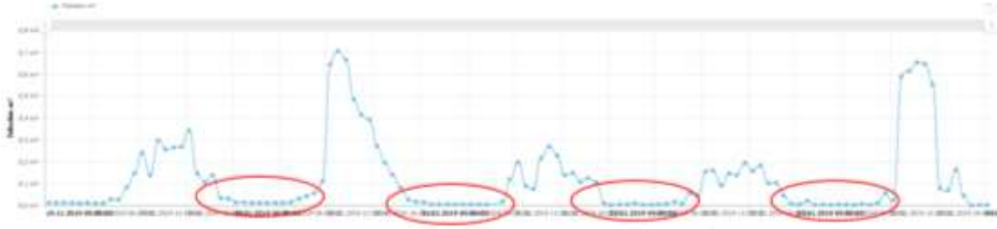
Şekil 4.169. 19.11.2019 tarihinden itibaren Olbia bayan tuvaletinde su sızıntılarının azaltılması
