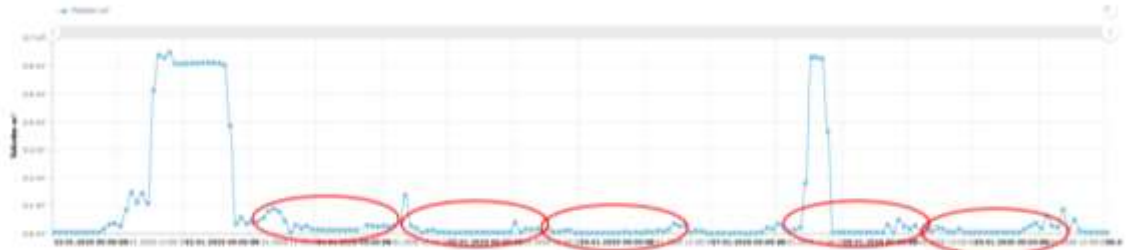
Şekil 4.171. 22.01.2020 tarihindeki müdahale sonrası Olbia bayan tuvaletinde su sızıntılarının azalması
