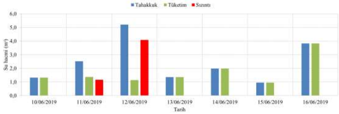
Şekil 4.23. Olbia bayan tuvaletinde 10.06.2019 – 16.06.2019 tarihleri arasındaki dönemde ölçülen toplam günlük tahakkuk su hacimleri, hesaplanan günlük sızıntı hacmi ve günlük tüketim su hacmi
