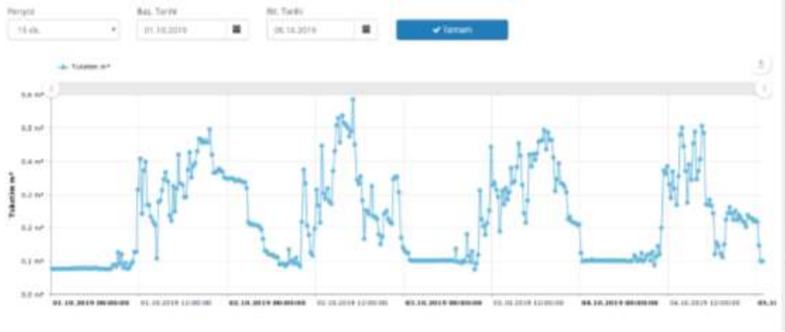
Şekil 4.1. Akdeniz Üniversitesi kampüsü içinde yer alan Yakut Çarşısı tuvaleti için kullanılan akıllı sayaçtan 01-05.10.2019 tarihleri için elde edilen su tüketimlerinin 15 dakikalık değişimlerini gösteren ekran görüntüsü
