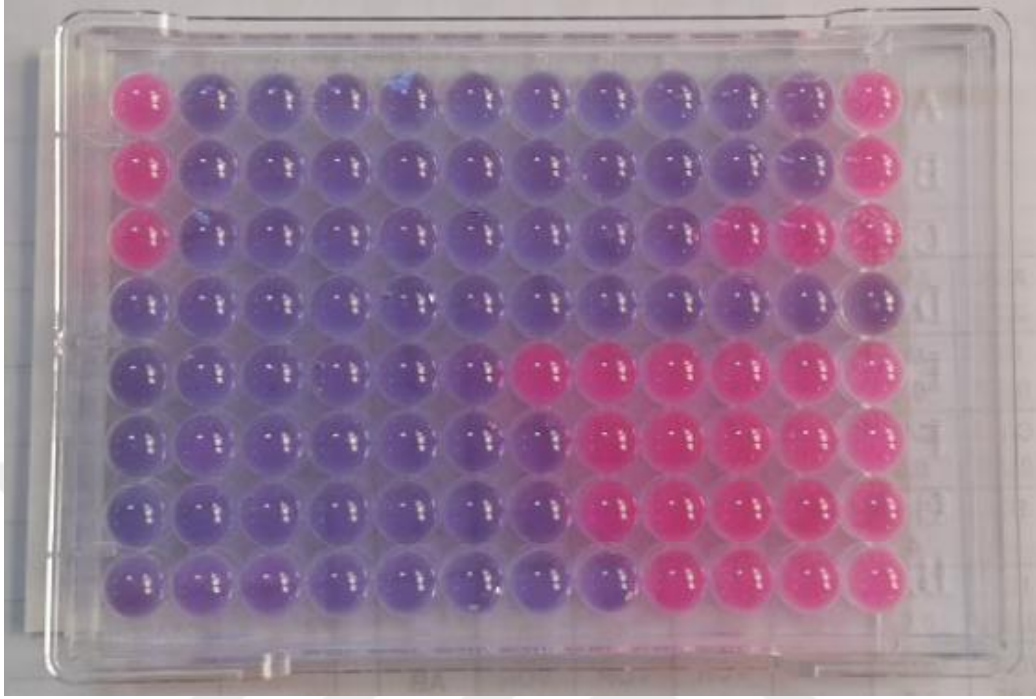
Şekil 3.1. The Sensititre Yeast One; kalorimetrik mikrodilüsyon yöntemi.
