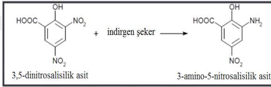
Şekil 4.2. \alpha -amilaz aktivitesinin 3,5-dinitrosalisilik asit (DNS) reaktifi ile tayini
