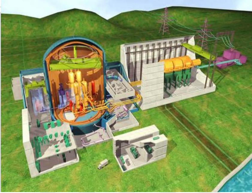
Şekil 20. VVER-1200 Reaktörün şematik gösterimi (URL-12, 2004).
