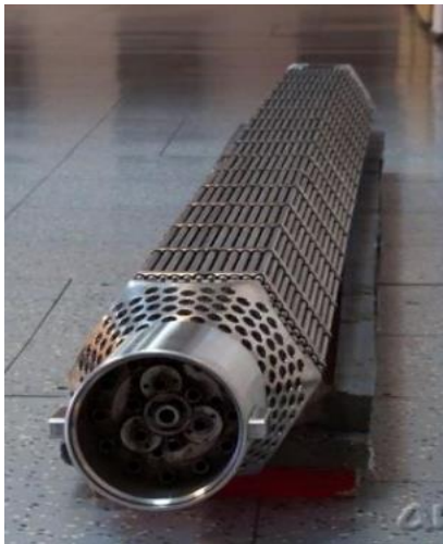
Şekil 22. VVER-1200 yakıt demeti (Acar, 2020).
