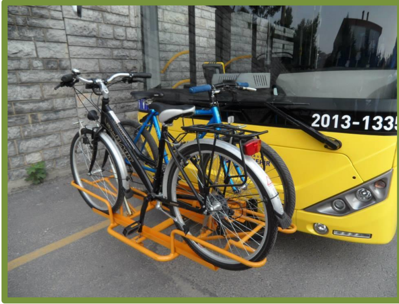
Resim 5.1. Önünde bisiklet rafı bulunan otobüs (Bisikletliler Derneği, 2012)
