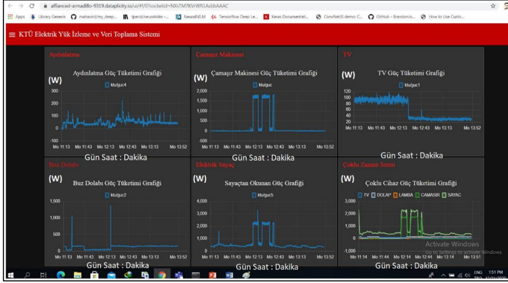
Şekil 16. KTÜ Gerçek Zamanlı Elektrik Güç İzleme ve Veri Toplama Sistemi
