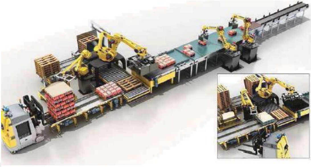
Şekil 2.2. Çatallı OYA'nın paletizer işlemi sonunda paleti alması
