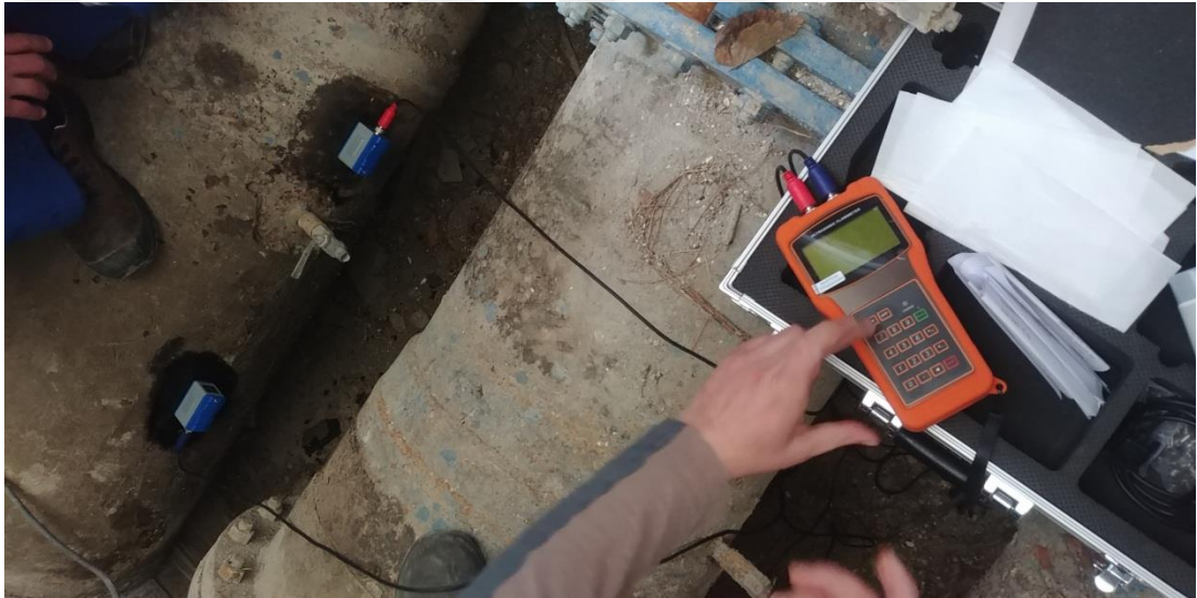
Şekil 4.1. Ultrasonik debimetre ile ölçüm
