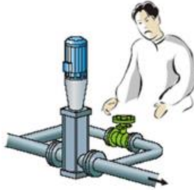
Şekil 2.27. Bypass vanası ile kontrol
