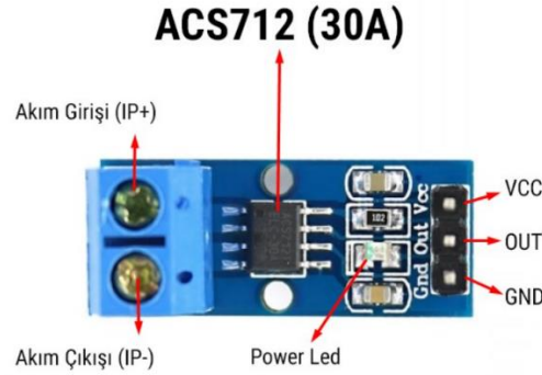
Şekil 27. ACS-712 Pin diyagramı
