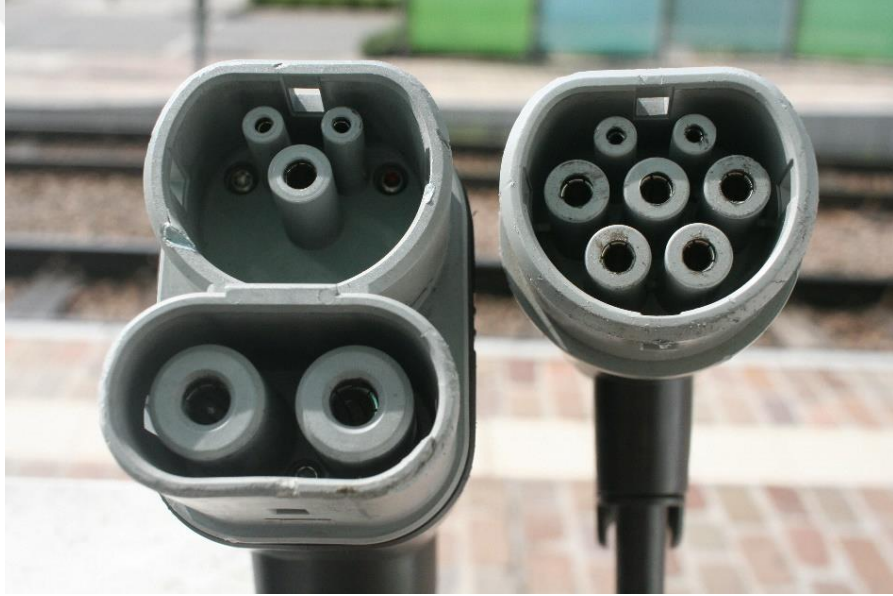
Şekil 4.13: CCS (Sol) ve IEC tipi (sağ) şarj soketi [52]
