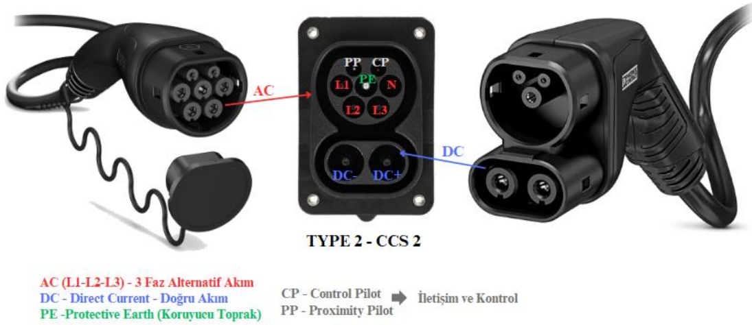
Şekil 3.10 : TYPE-CCS şarj soket yapısı.
