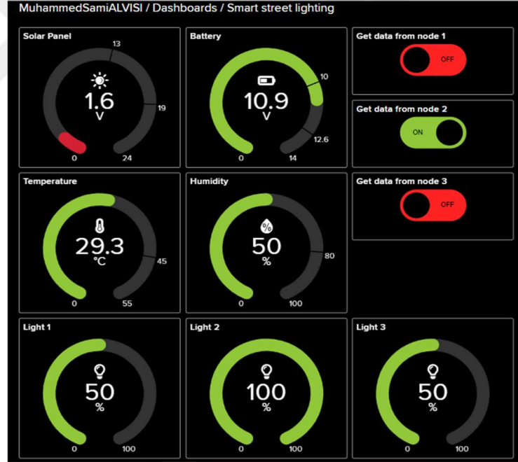
Şekil 4. 6. İkinci durum için Adafruit IO kullanarak akıllı sokak aydınlatma sisteminin izlenmesi
