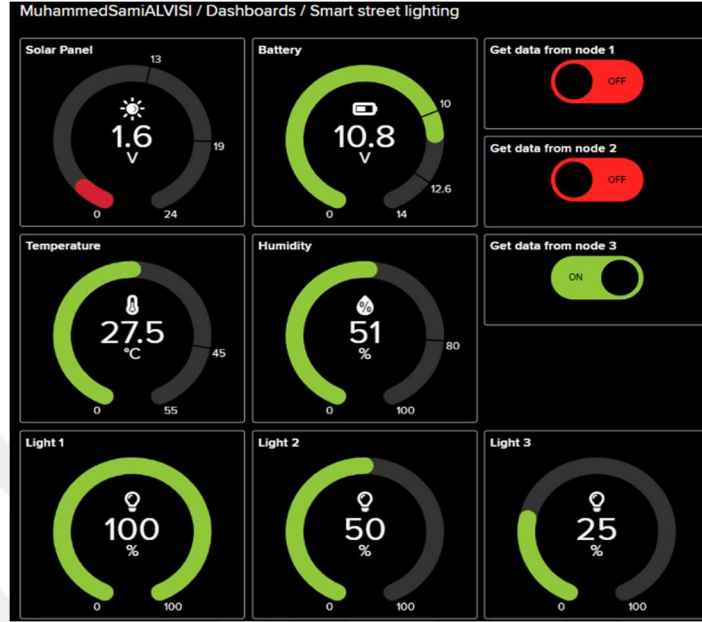
Şekil 4. 3. Birinci durum için Adafruit IO kullanarak akıllı sokak aydınlatma sisteminin izlenmesi
