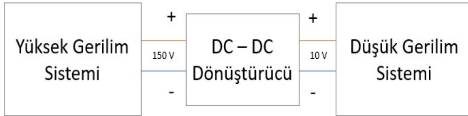
Şekil 3. 17. DC-DC dönüştürücünün çalışma prensibi
