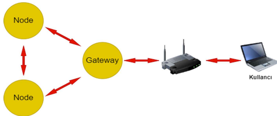
Şekil 3. 25. Kontrol sisteminin blok diyagramı
