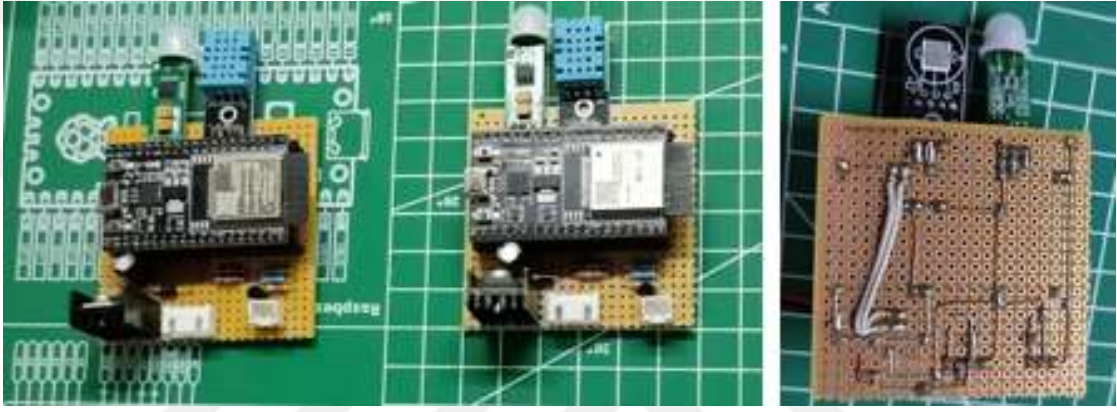
Şekil 3. 45. Düğüm devreleri önden ve arkadan görünümü
