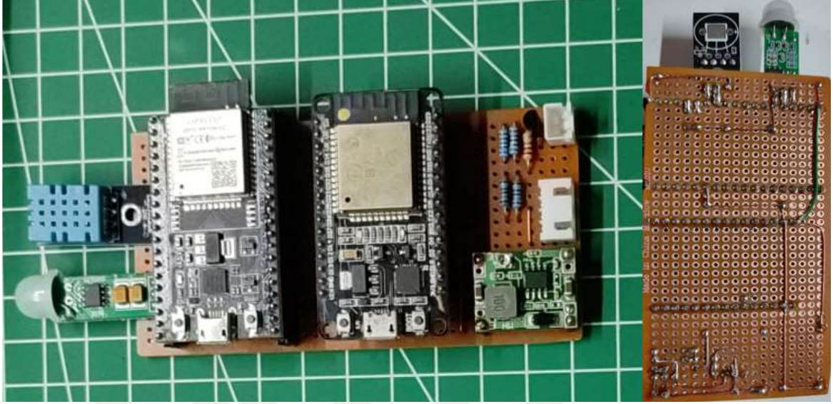
Şekil 3. 44. Ağ geçidi devresinin ön ve arka yüzü görünümü
