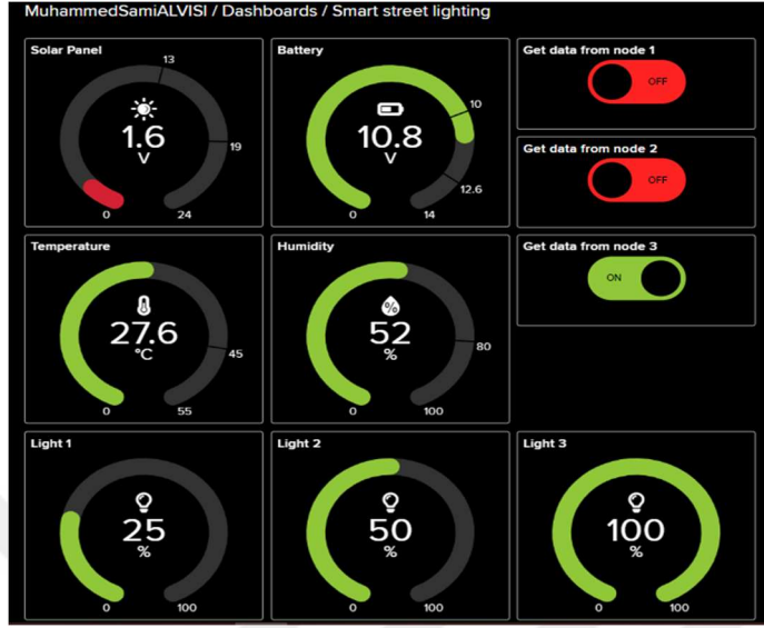
Şekil 4. 9. Üçüncü durum için Adafruit IO kullanarak akıllı sokak aydınlatma sisteminin izlenmesi
