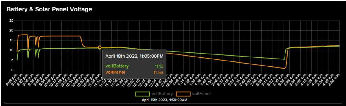
Şekil 3. 43. Güneş paneli ve pil gerilimlerinin zamanla değişimi
