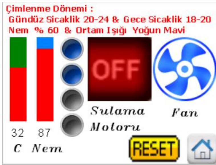
Şekil 5.6. Nextion programı ile gözlenen soğutma fanı
