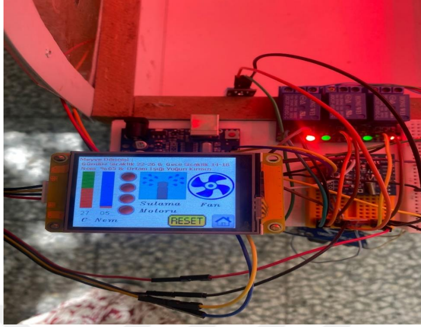
Şekil 5.17. Nextion ekranı ile sistem değişkenleri bilgisinin alınması
