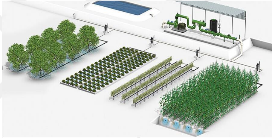
Şekil 3.16. Damla sulama sistemi örneği
