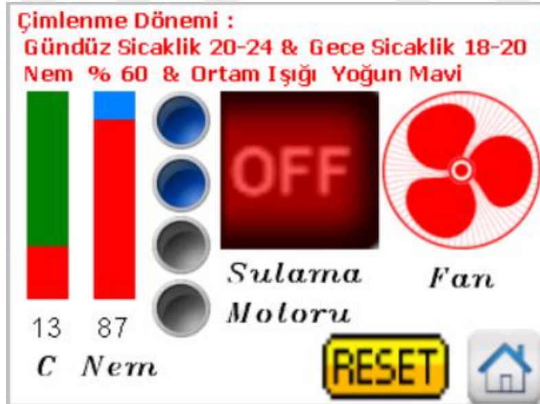
Şekil 5.4. Nextion ekranı ile gözlenen ısıtma fanı
