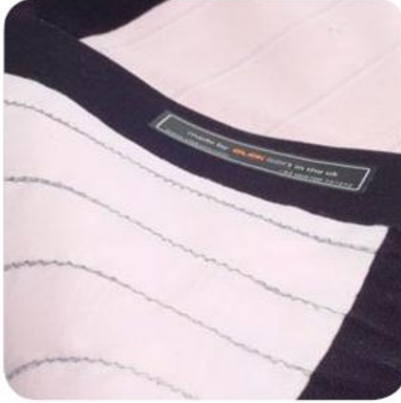
Şekil 4.31. Nemi Algılayan Kumaş [ www.eleksen.com , 2005]
