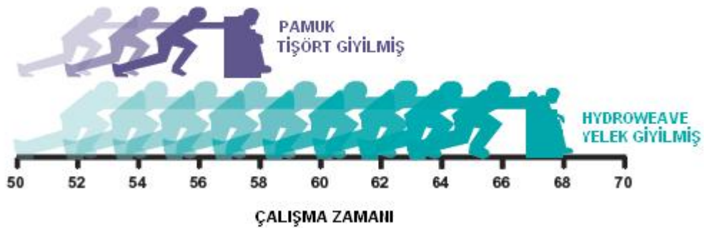
Şekil 4.13. Hydroweave® Teknolojisi Kullanılarak Elde Edilmiş Giysinin, Giyildiği ve Giyilmediği Durumlarda Çalışma Zamanlarının Karşılaştırılması [ www.silvereagleoutfitters.com , 2006]
