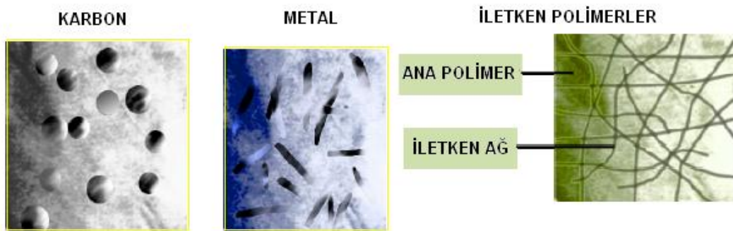
Şekil 4.34. Elektroiletken Bileşiklerin Tozuyla Doldurulmuş Polimerler [Deguillement, 2003]
