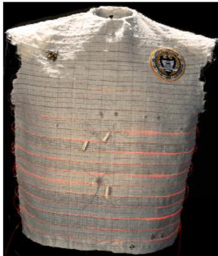
Şekil 4.37. Hayati Sinyalleri Tespit Eden Giysiler (Smart Shirt) [Lopez, 2005]
