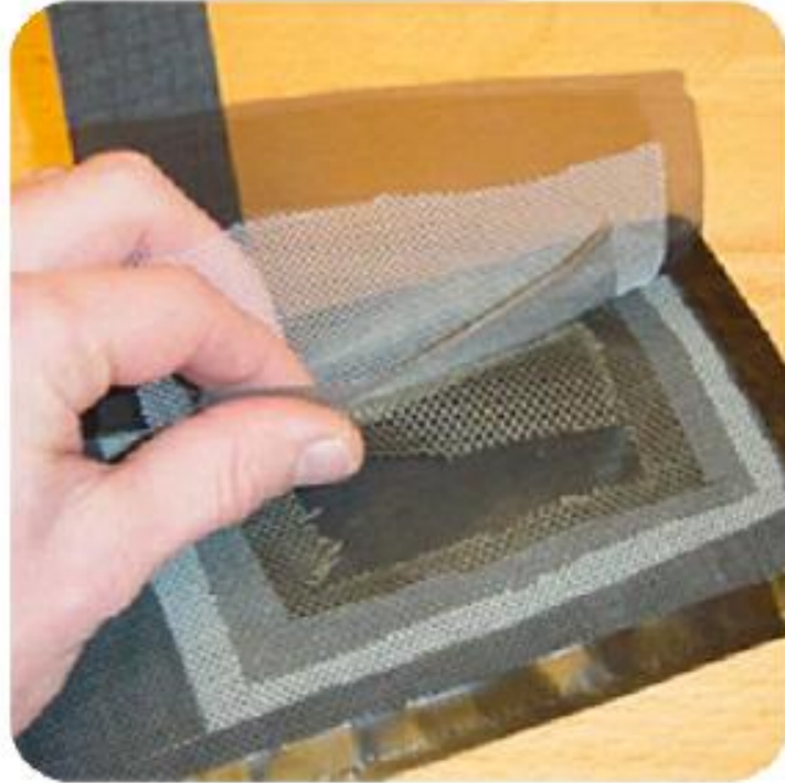
Şekil 4.28. Dokunulmaya Karşı Hassas Kumaşın, Çok Katlı Yapısının Görüntüsü [ www.eleksen.com , 2005]
