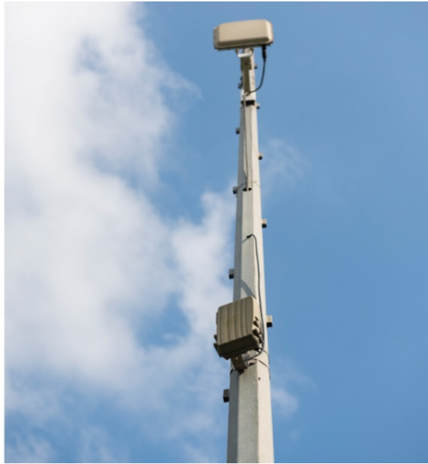
Şekil 1.3. Ortalama seyahat süresi ve EDS koridorları vaka çalışmalarında kullanılan antenli sınıf 1 tipi Bluetooth okuyucu cihazı (300m menzil)
