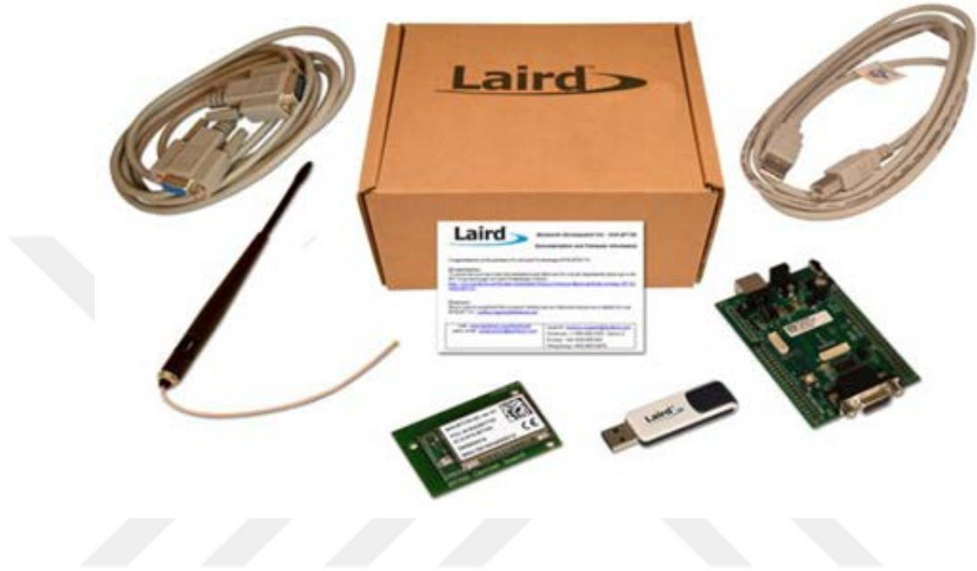
Şekil 1.3. Ortalama seyahat süresi ve EDS koridorları vaka çalışmalarında kullanılan antenli sınıf 1 tipi Bluetooth okuyucu cihazı (300m menzil)
