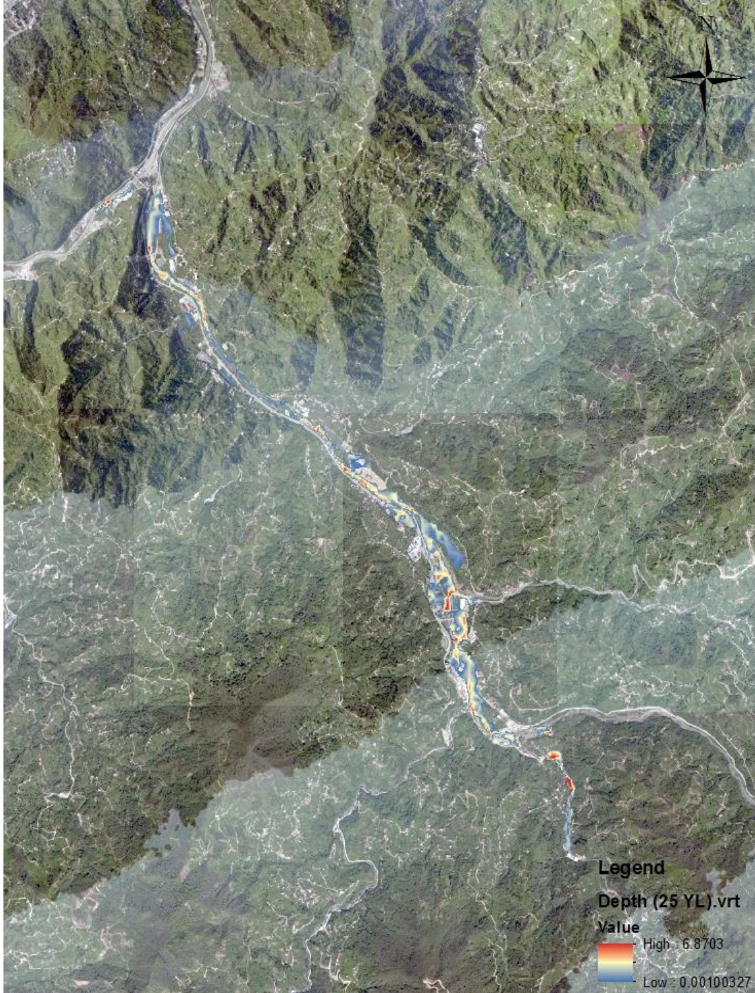
Şekil 27. Taşkın simülasyonu sonucu, T-25, Güneysu Deresi, Rize
