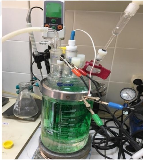
Şekil 5.1. Çevrimsel voltametri çalışmalarında kullanılan deney düzeneği.
