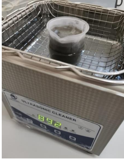
Şekil 3.5. B 4 C tozların ultrasonik karıştırıcıda hazırlanması
