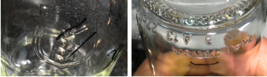
Şekil 5.1 : Cam şişelerde meydana gelen gravür dibi çatlakları.
