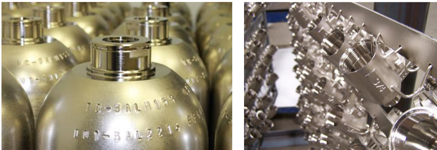
Şekil 2.11 : Kimya sektöründe kullanılan akımsız nikel kaplamalı çeşitli parçalar.
