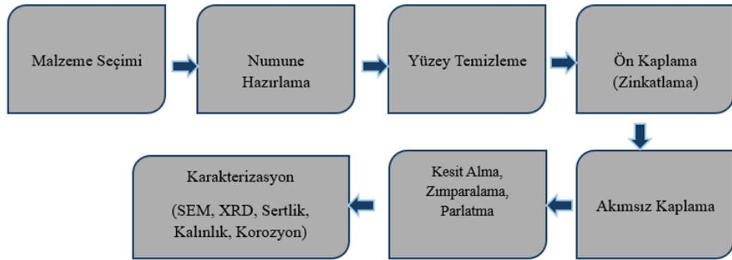
Şekil 4.4. Akımsız NiBPT kaplama işlemleri akım şeması.
