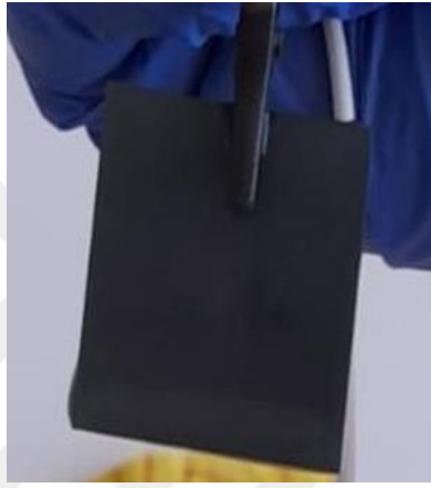
Şekil 4.3. Ön kaplama(zinkatlama) işlemi yapılmış olan alüminyum altlık.
