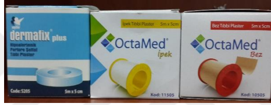
Şekil 2.1 Piyasadan temin edilen ve zemin malzemesi olarak çalışmada kullanılan soldan sağa sırasıyla şeffaf, ipek ve bez yapışkan plaster bantlar (Kişisel arşiv, 2019)
