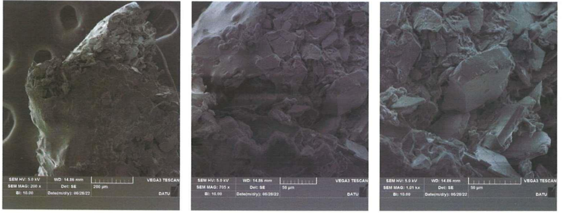
Şekil 4.94: 7 Numaralı Numunenin Islak Yüzey Temizliği Sonrası SEM Görüntüsü
