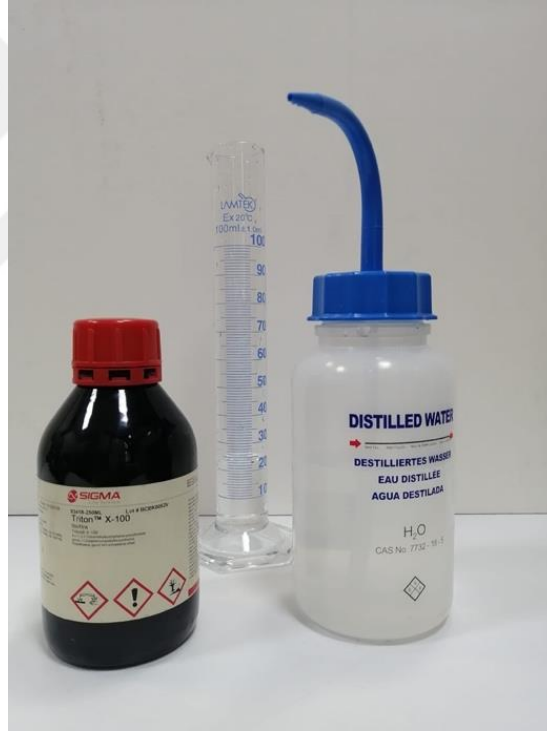
Şekil 4.59: Triton X-100 (octylphenol ethoxylate) 23ml, 95 ml saf su (İstanbul Üniversitesi, Edebiyat Fakültesi, Kültür Varlıklarını Koruma ve Onarım Bölümü, Tablo Koruma ve Onarım Laboratuvarı)
