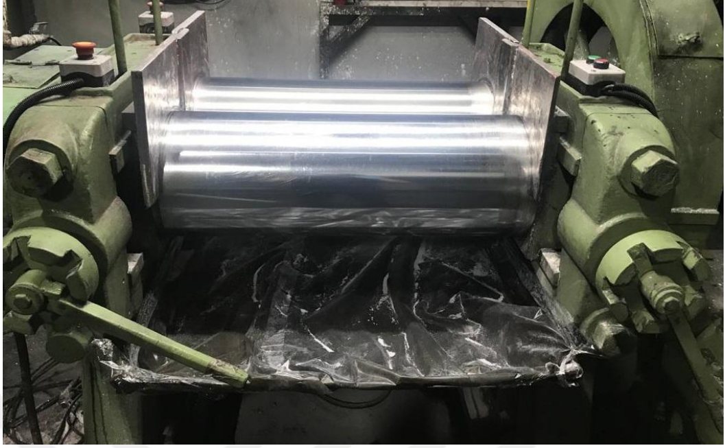
Şekil 2.1. Açık karıştırıcı hamur makinesi (Silindir)
