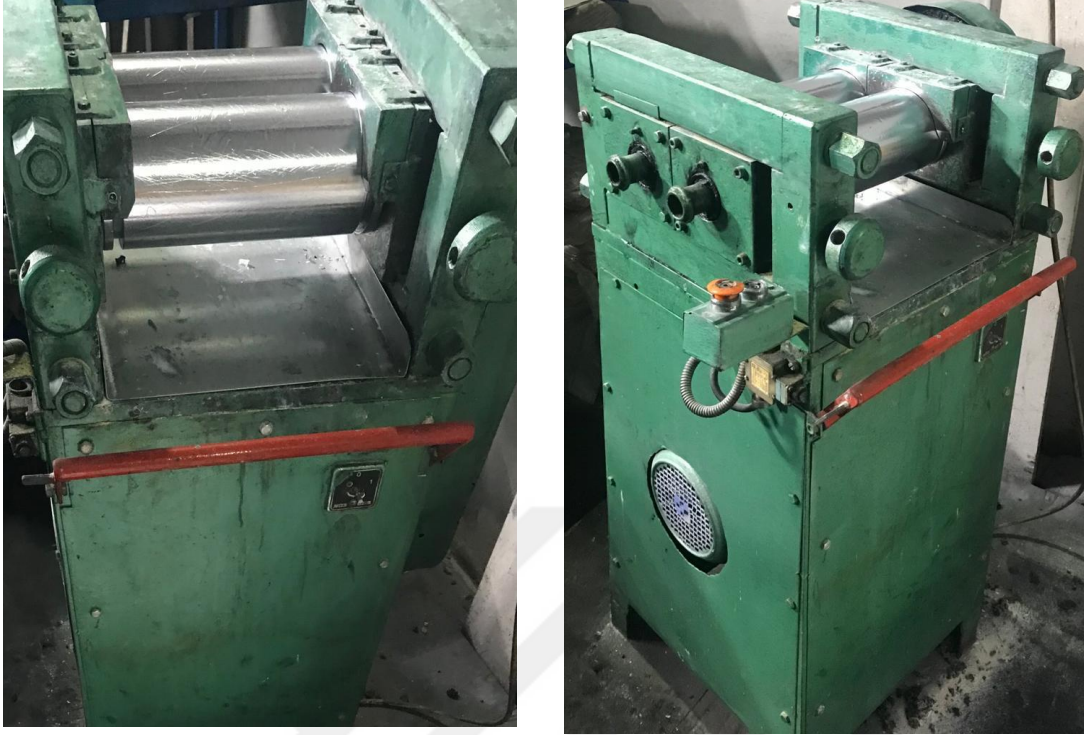
Şekil 2.2. Laboratuvar tipi açık karıştırıcı hamur makinesi
