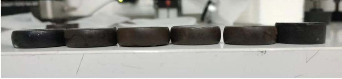
Şekil 3.4. Soldan sağa doğru sırasıyla gösterilen, kalıcı deformasyon sonrası numuneler yükseklik farklar
