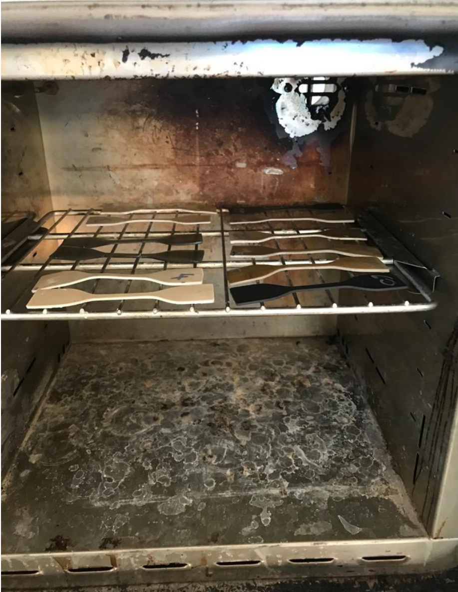
Şekil 2.7. Etüv cihazında postkür uygulanan çekme – uzama test numuneleri
