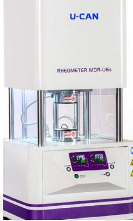
Şekil 2.4. U-CAN marka reometre cihazına örnek bir fotoğraf [47]
