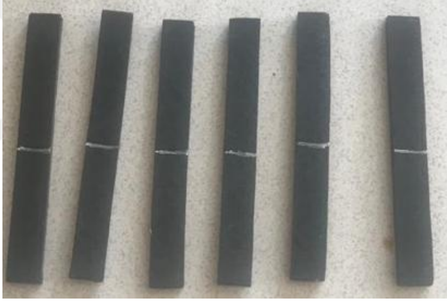
Şekil 2.11. LOI test numunelerinin 5'er cm' lik işaretlenen alanları
