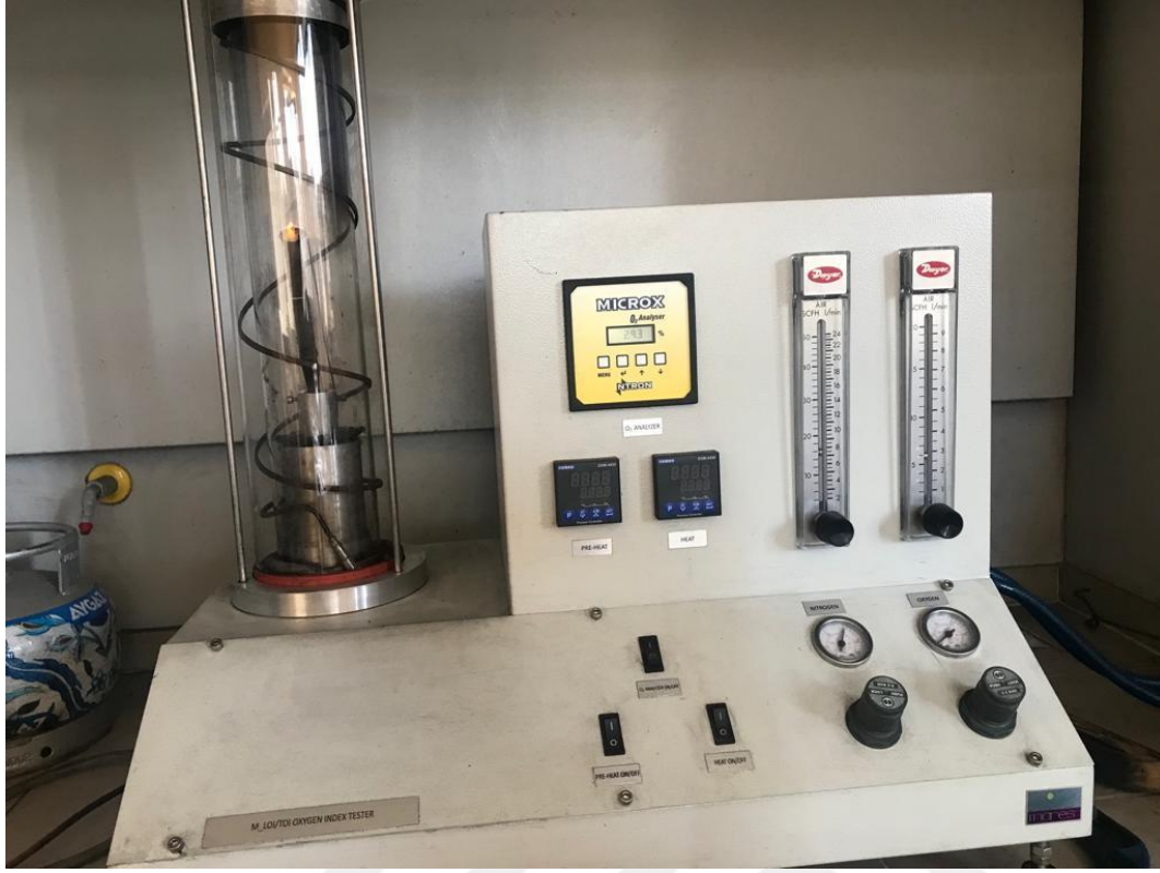
Şekil 2.12. Kocaeli Üniversitesi'nde yer alan MARES marka LOI Test Cihazı
