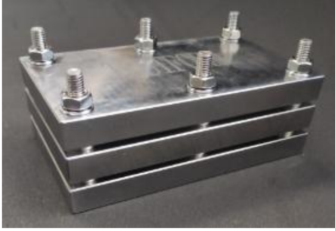
Şekil 2.9. Kalıcı deformasyon için kullanılan benzer test aparatı
