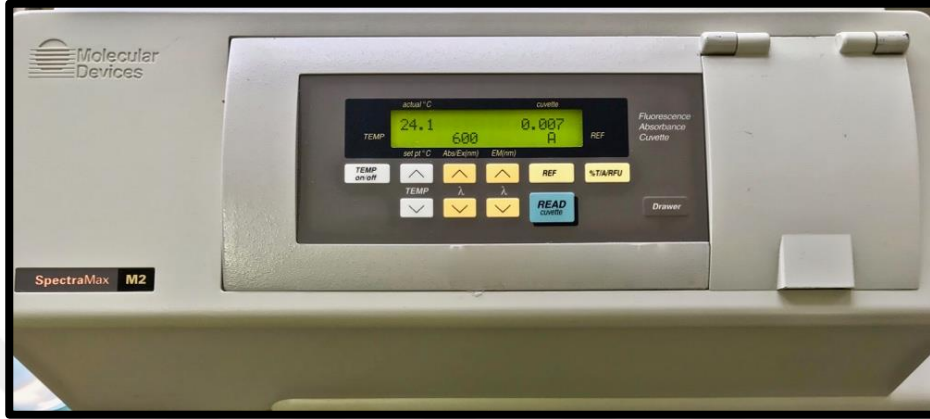
Resim 20. Optik dansitelerin ölçüldüğü spektrofotometre cihazı
