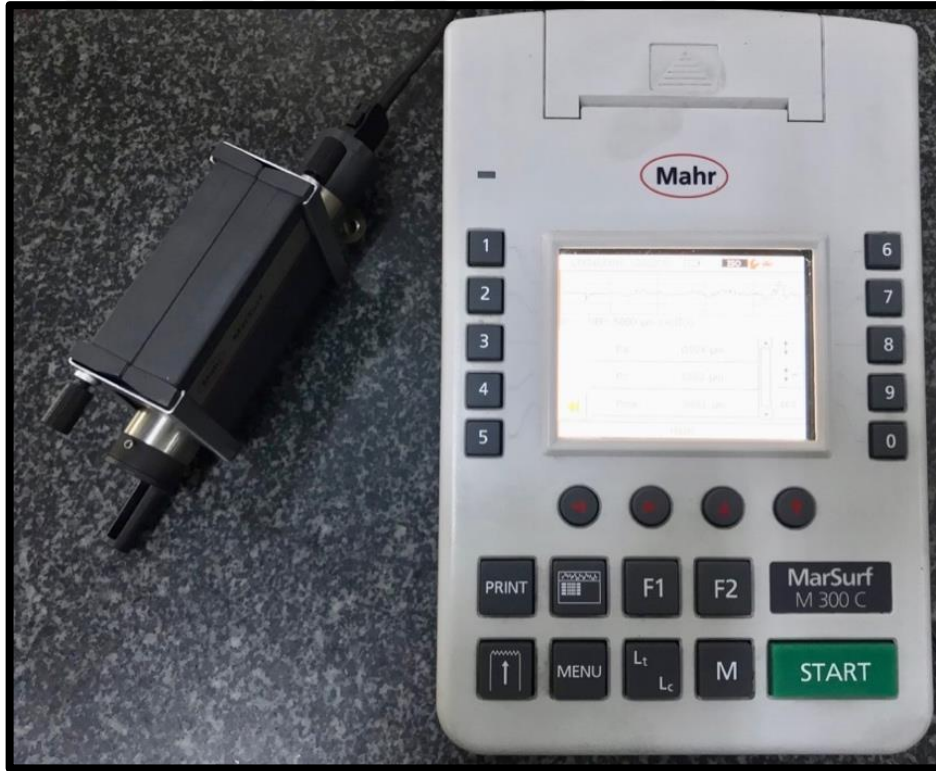
Resim 16. Yüzey pürüzlülüğü ölçümlerinin yapıldığı kontakt profilometre cihazı
