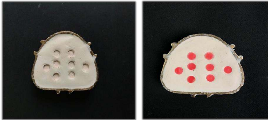
Resim 11. Alçıya gömülen disk şekilli mum örneklerin negatifleri ve mum disklerin muflaya alınması
