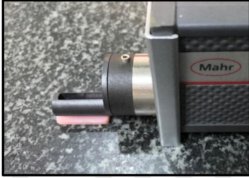
Resim 17. Yüzey pürüzlülüğü ölçüm yöntemi
