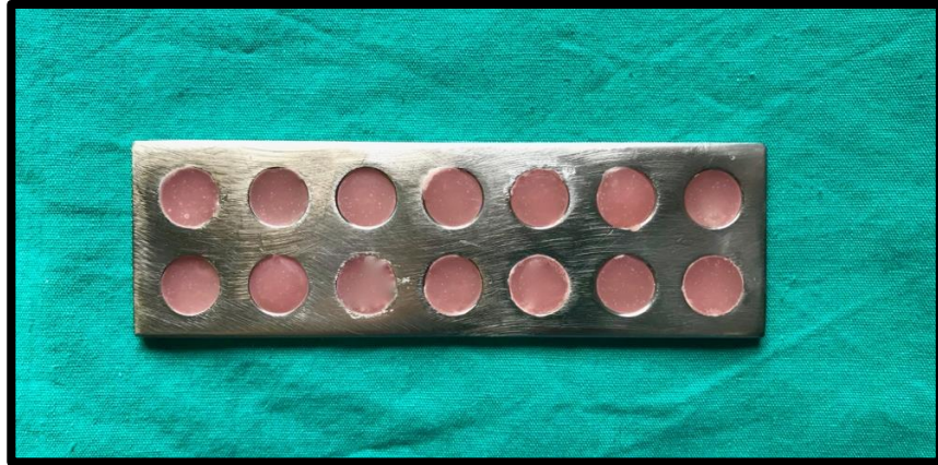
Resim 15. Meliodent otopolimerize akrilik disk örneklerin hazırlanışı
