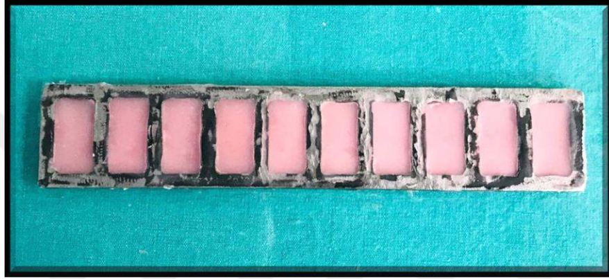
Resim 14. Meliodent otopolimerize dikdörtgen şekilli akrilik örneklerin hazırlanışı
