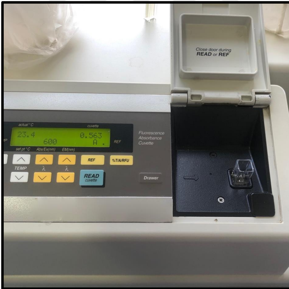
Resim 21. Spektrofotometre cihazında optik dansite ölçümü
