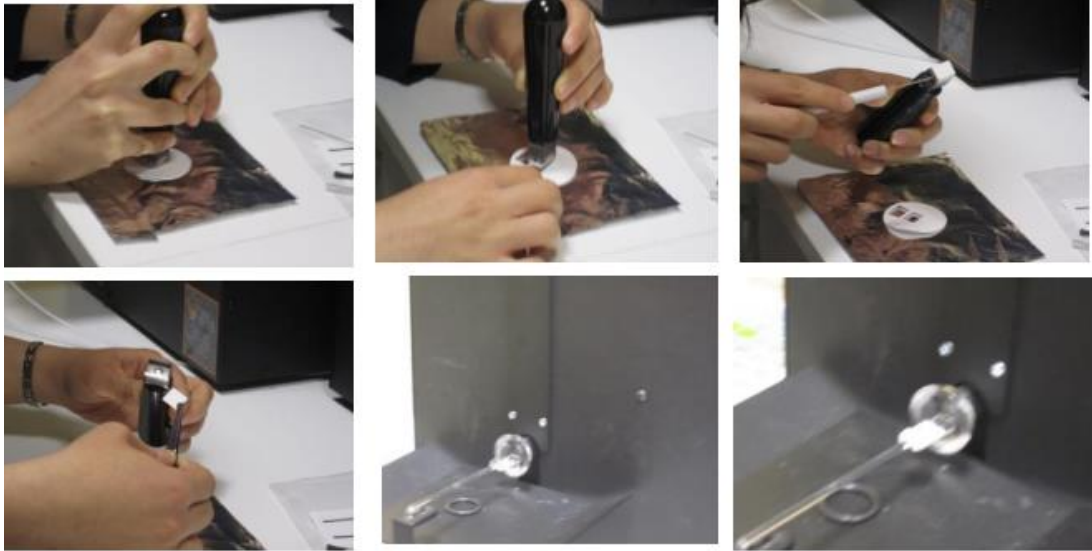
Şekil 3.6. Filtre örneğinden analiz için kesilen kısım ve cihaza yerleştirilmesi.
