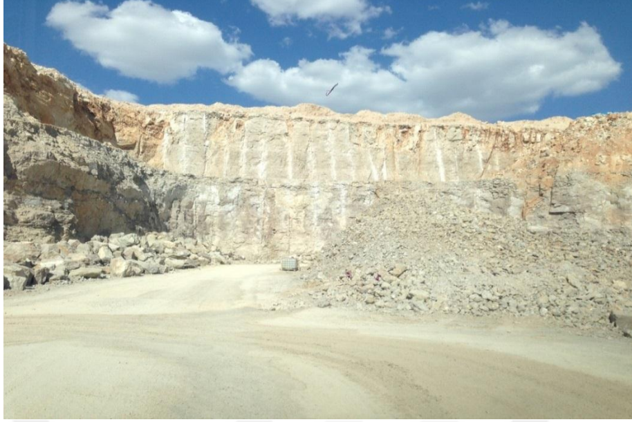
Şekil 3.37: Ocak basamakları genel görünüş (doğru uygulama).
