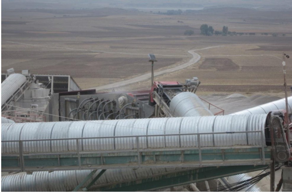
Şekil 3.22: Üzeri kapalı bant konveyör (doğru uygulama).
