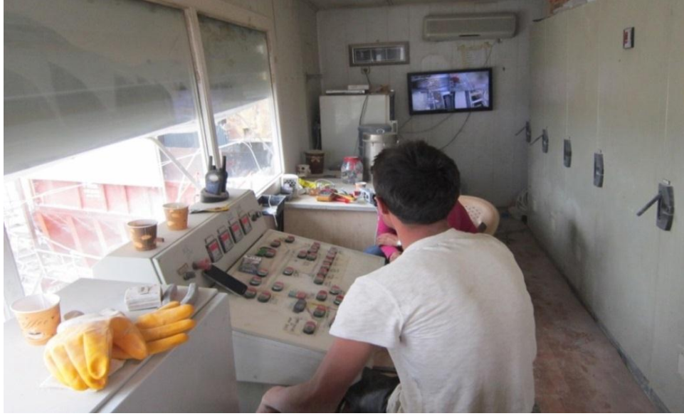
Şekil 3.11: Kameralı sistemle kırıcı ağız kontrolü (doğru uygulama).
