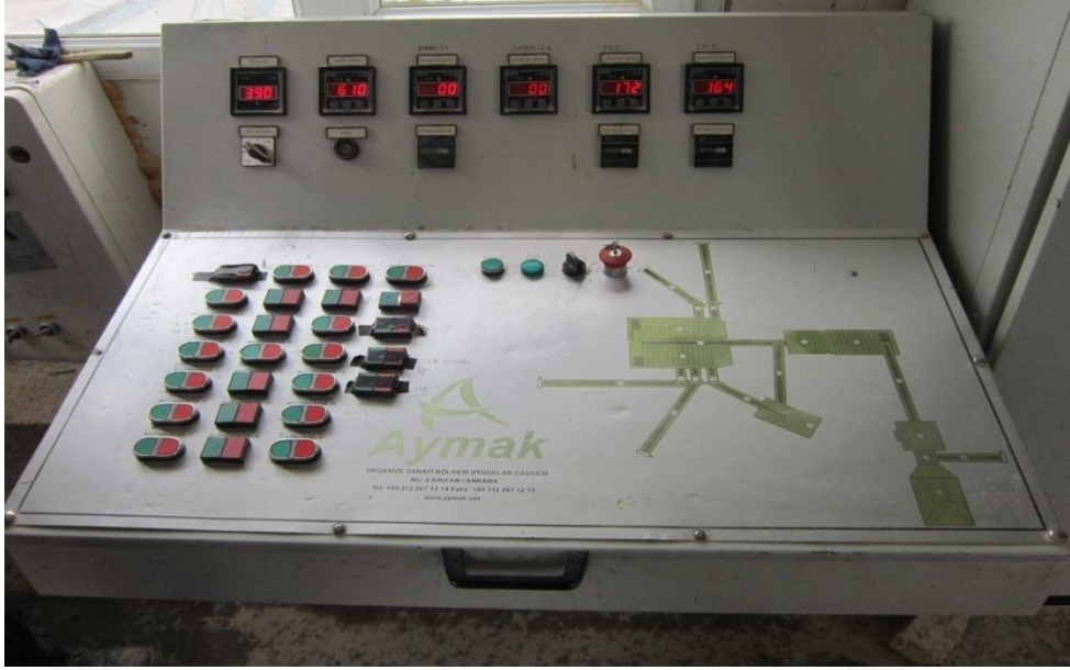
Şekil 3.17: Kontrol cihazı ve acil durdurma butonları genel görünüş.
