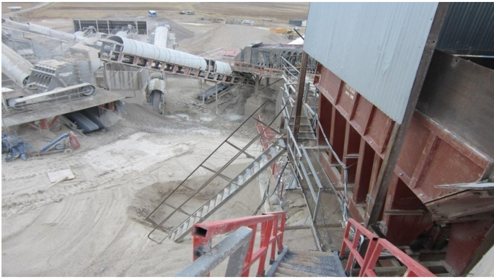
Şekil 3.24: Geçiş yolları ve korumalıklar (doğru uygulama).
