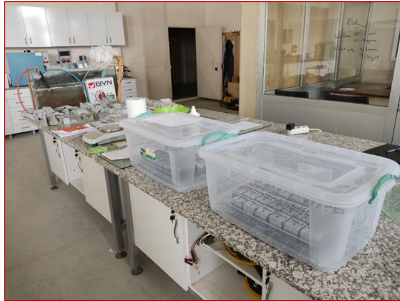
Şekil 4.17. Numunelerin suya doymuş hale getirilmesi sürecinden bir görünüm.
