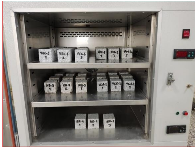
Şekil 4.13. Kurutulmak üzere etüve konulan numunelerden bir görünüm.
