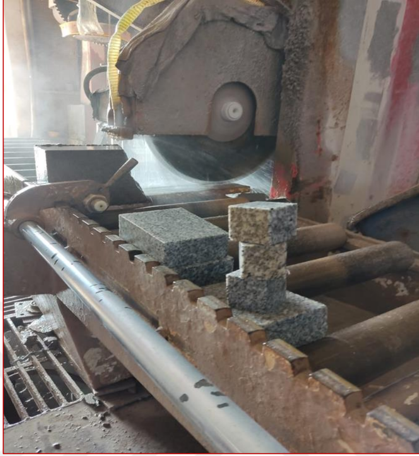
Şekil 4.12. Çalışma alanından alınan numunelerin taş kesim makinasında 50x50x50 mm ebatlarında boyutlandırması.
