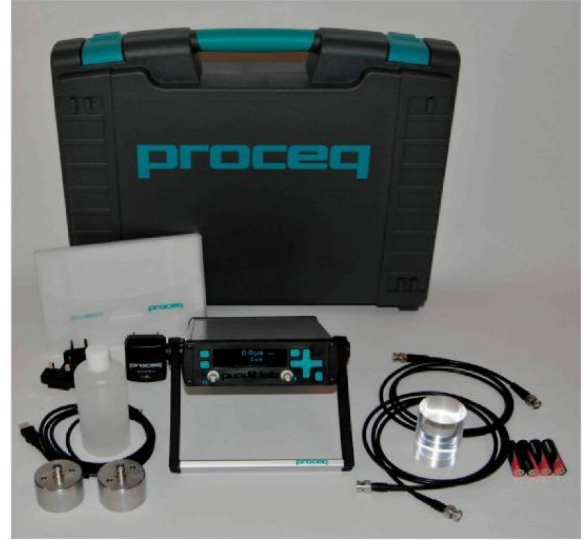
Şekil 4.23. Ultrasonik hız ölçüm cihazı ve şematik çalışma kesiti.
