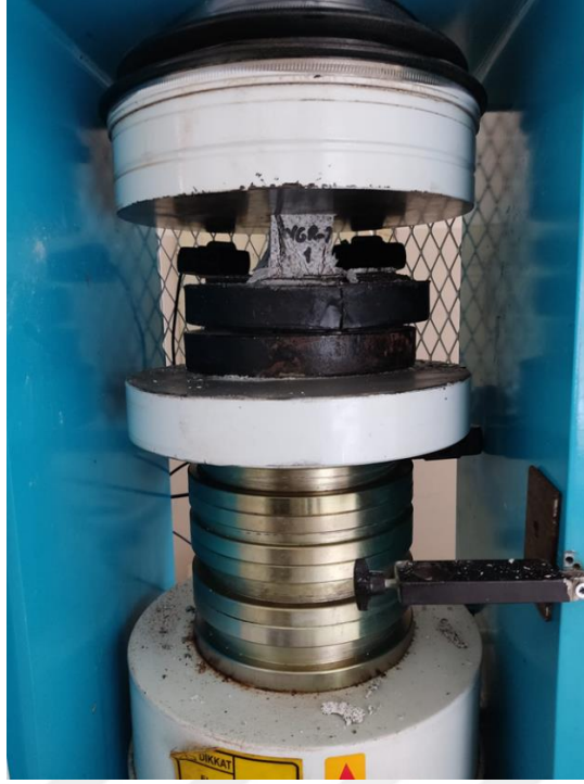
Şekil 4.29. Tek eksenli basınç analizinde numune yenilme anı.
