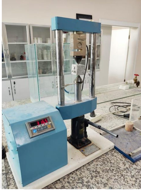
Şekil 4.27. Nokta yükleme cihazında çalışma alanı granit örneğinin dayanım analizi.
