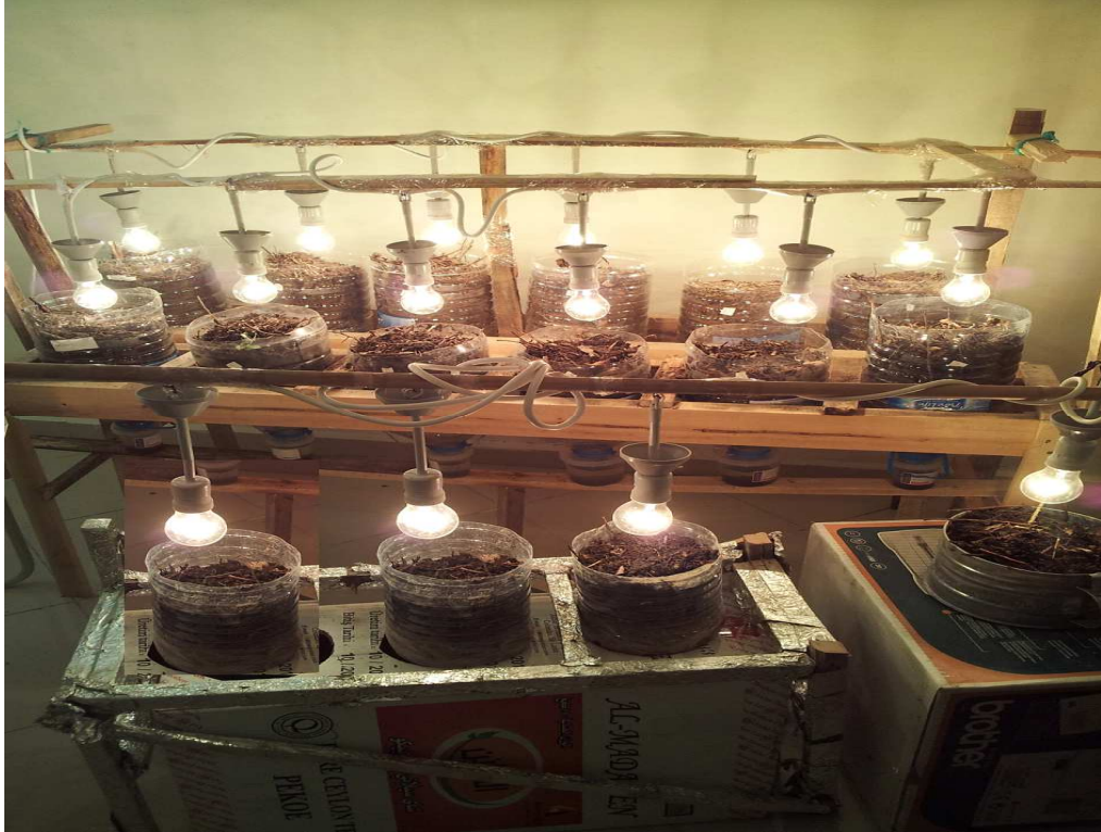
Şekil 4.1.3: Laboratuvar çalışma ortamında kullanılan berlese hunileri.
