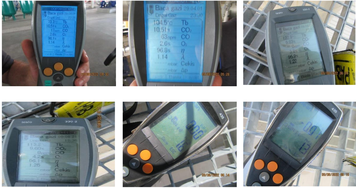
Şekil 44: Sıcak Su ve Buhar Kazanları Baca Gazı Ölçümleri
