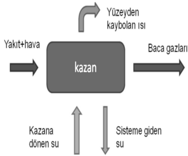
Şekil 37: Kazan Sisteminde Enerji Akış Şeması
