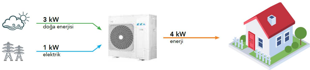
Şekil 2: Isı Pompasının Enerji Dönüşüm Prensibi
