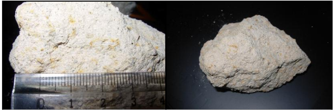
řekil 3.7: Selime Tüfünün makroskopik ve ierisindeki pümislerin görünümü.
