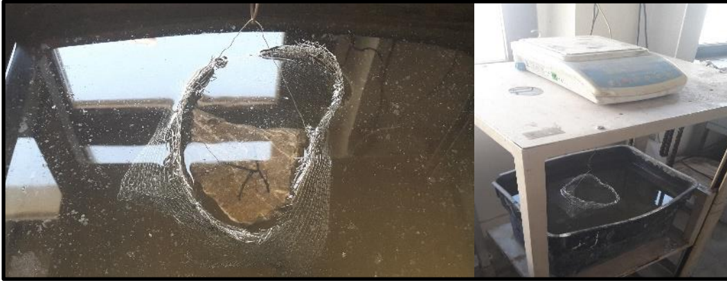
Resim 3.15. Arşimet Terazisi Düzeneginde Numuneler
