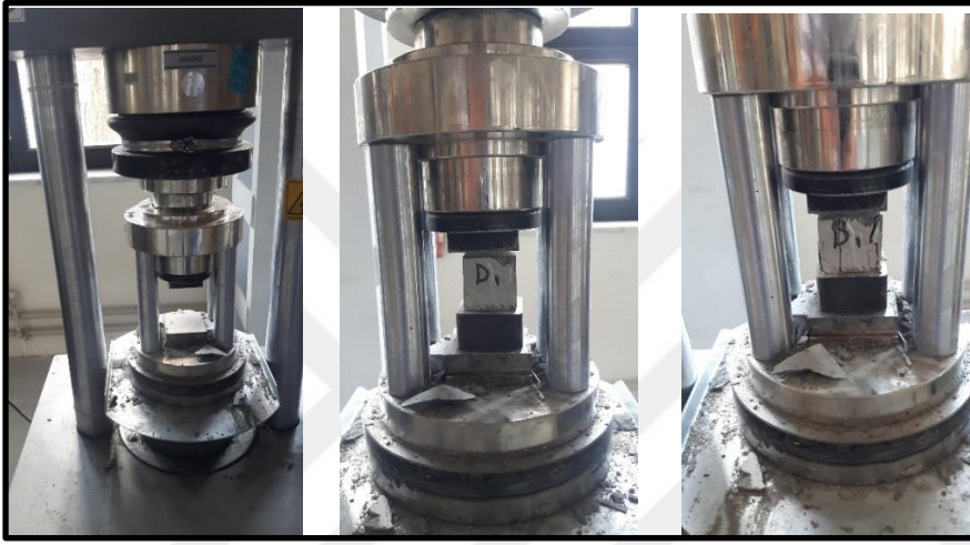
Resim 3.24. Basınç Dayanım Deneyi Görselleri
