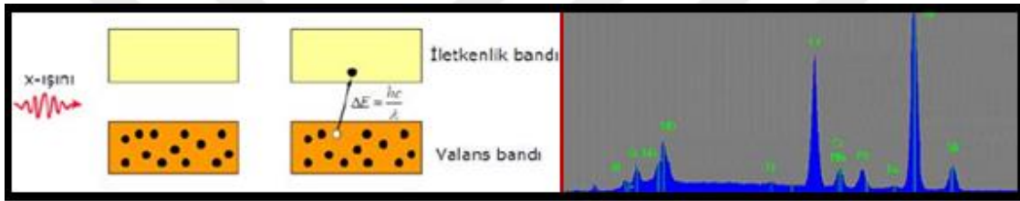
Şekil 3.7. EDS Çalışma Prensibi ve EDS Haritası [53]
