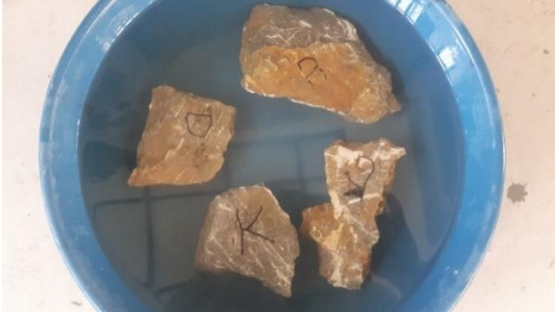
Resim 3.14. Suda Bekletilen Numuneler
