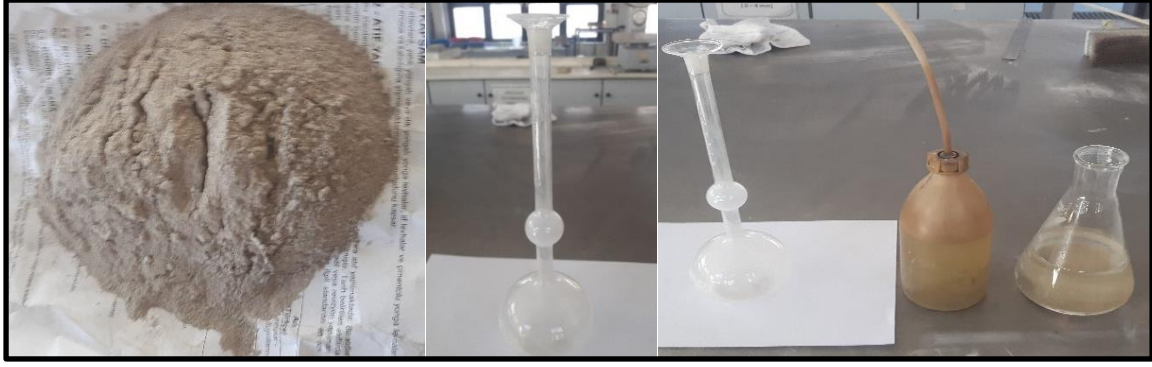
Resim 3.26. Öğütülmüş Numune, Le Chatelier Balonu Ve Yoğunluk Deneyi
