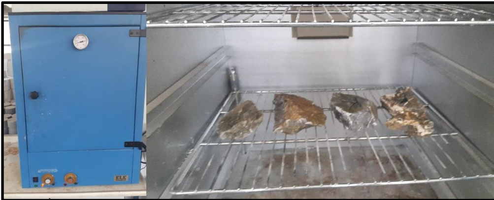
Resim 3.16. 300 Derece Kapasiteli Etüv Ve Etüv İçindeki Numuneler
