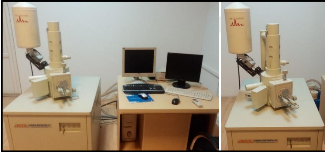
Resim 3.27. JEOL JSM 6060 VL marka SEM-EDS Cihazı
