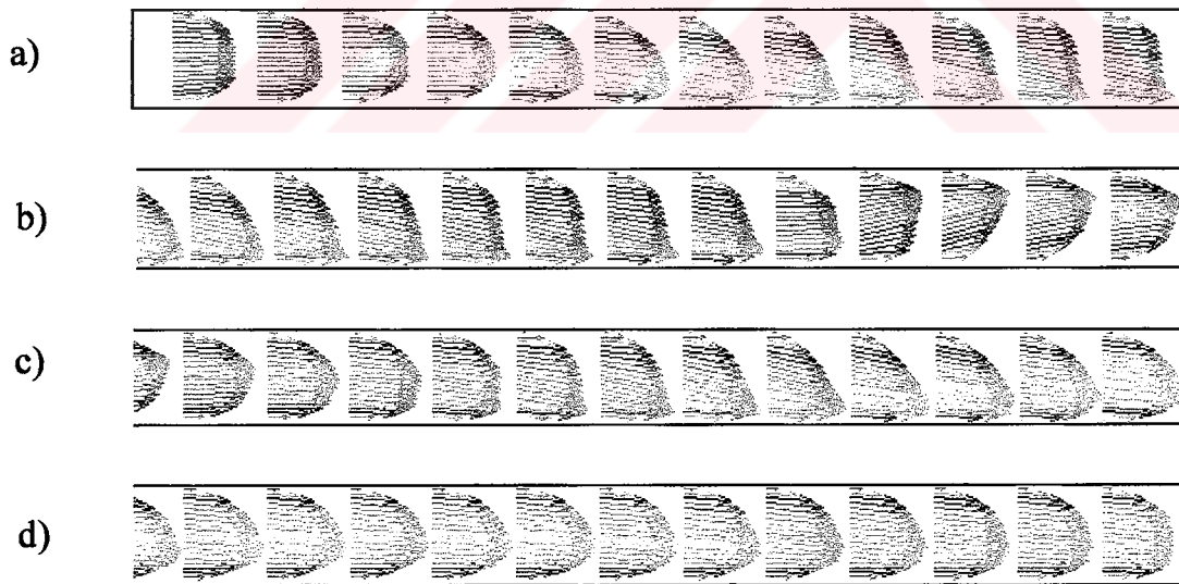
Şekil 4.19 Re=250 ve Gr^* = 5.0E+6 için sabit özellikler yaklaşımı ile elde edilen hız vektörleri. a) z = 0 - 0.25 m. b) z = 0.25 - 0.5 m arası c) z = 0.5 - 0.75 m arası d) z = 0.75 - 1 m arası.
