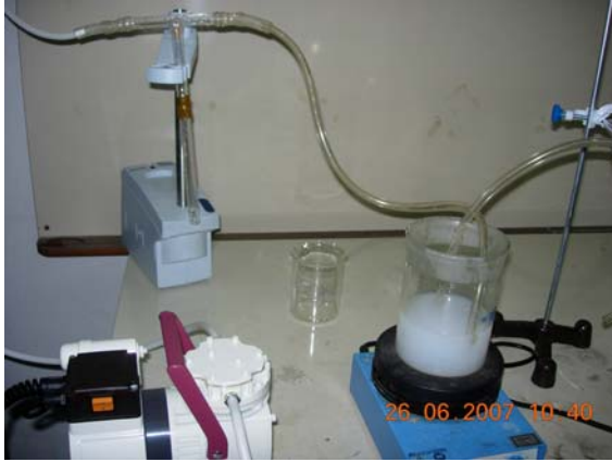
Resim 4.1. Desteğin alumina ile modifikasyonunda kullanılan deney düzeneğinin fotoğrafı
