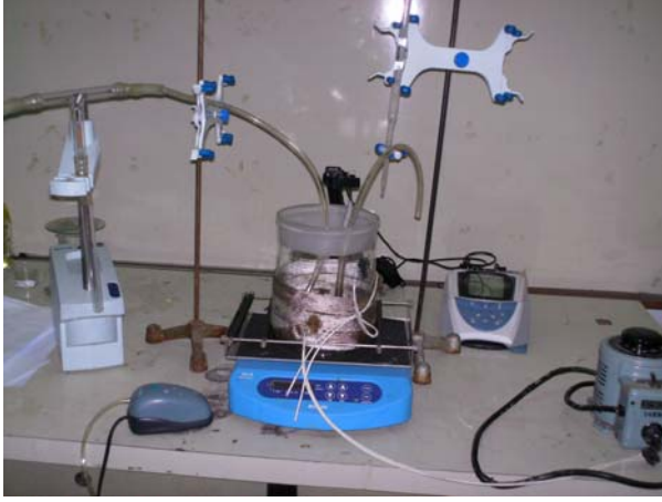
Resim 4.6. Vakum altında yürütülen kaplama çalışmalarına ait deney düzeneğinin fotoğrafı
