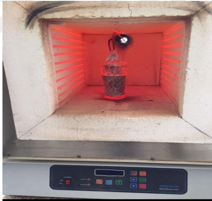
Şekil 4.1. Piroliz deneylerinin yapıldığı reaktör ve fırın
