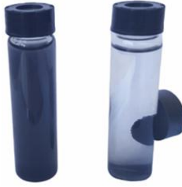
Şekil 5.8. Aktif karbon destekli katalizörlerin dıştan mıknatıs uygulanması ile manyetiklik özelliğinin gösterimine örnek
