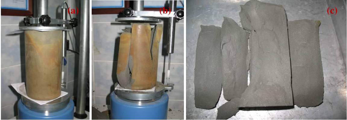
Şekil 3.65. LSS ile aktive 6000 \text{ cm}^2/\text{g} özgül yüzey alanlı nötr cüruf numunelerinin 360 günlük kür süresi sonunda görünümü
