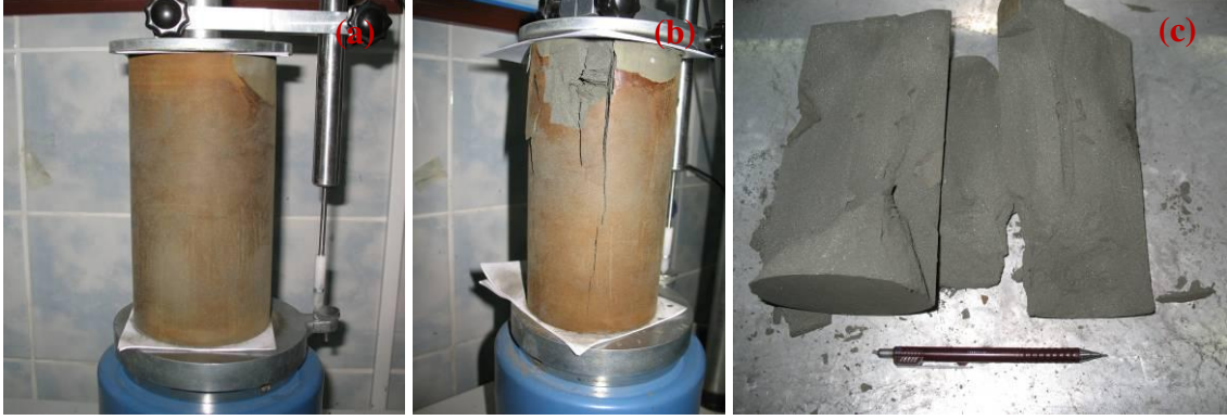
Şekil 3.64. LSS ile aktive 3150 \text{ cm}^2/\text{g} özgül yüzey alanlı nötr cüruf numunelerinin 360 günlük kür süresi sonunda görünümü
