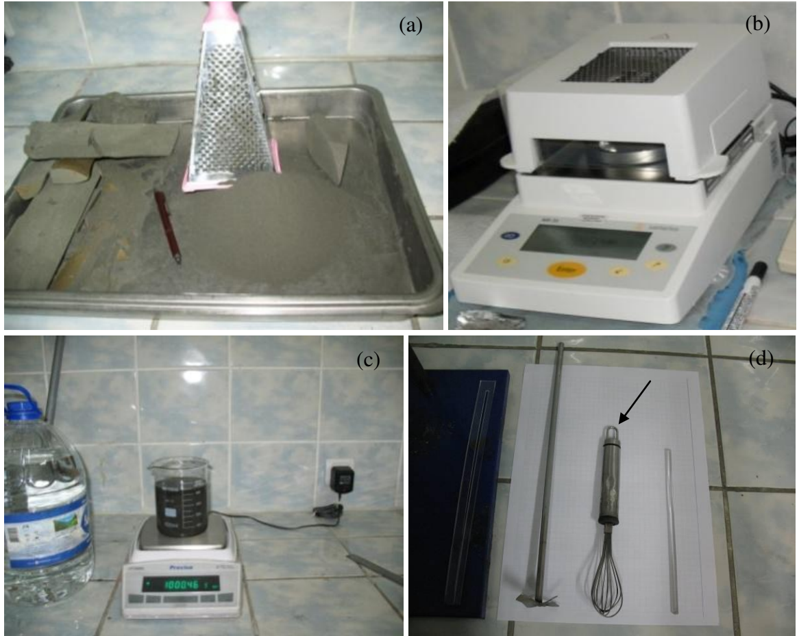
Şekil 2.12. Asit ve sülfat analizleri için numunelerin rendelenmesi (a), nem içeriklerinin tayini (b), katı sıvı oranının %50'ye ayarlanması (c), mikserle karıştırılması (d)
