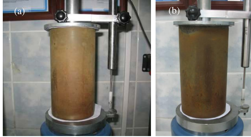
Şekil 3.11. 360 günlük kür sürelerinde %7 NC-LSS (a) ve AC-LSS numuneleri (b)
