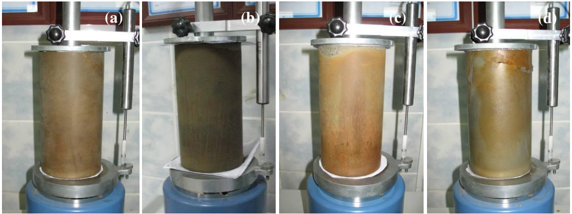
Şekil 3.53. 360 günlük kür süresinde %8 Na 2 O dozajında 1,0 modül (a), NC-LSS 2,0 modül (b), AC-LSS 1,0 modül (c) ve AC-LSS 2,0 modül için numunelerin fiziksel görünümü
