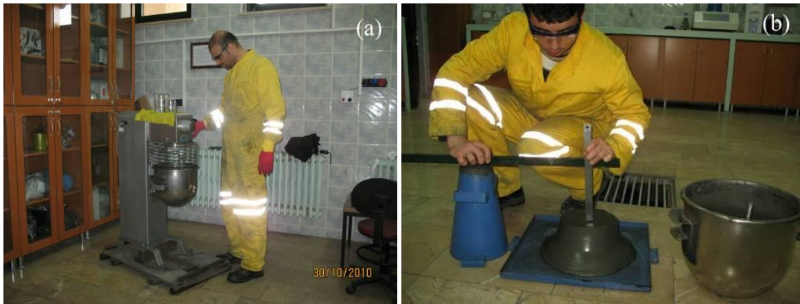
Şekil 2.9. Macun dolgu malzemesinin mikserde karıştırılması (a), kıvamının ölçülmesi (b)
