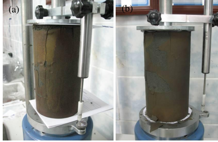
Şekil 3.10. 360 günlük kür sürelerinde %5 NC-LSS (a) ve AC-LSS numuneleri (b)
